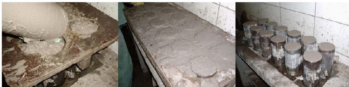
Figura 47: moldagem dos corpos-de-prova de CAA sem compactação
