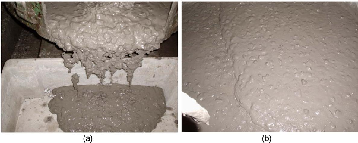
Figura 46: aspecto do CAA em movimento com (a) agregado graúdo e argamassa coesos em queda livre e (b) agregado graúdo e argamassa coesos em espalhamento
