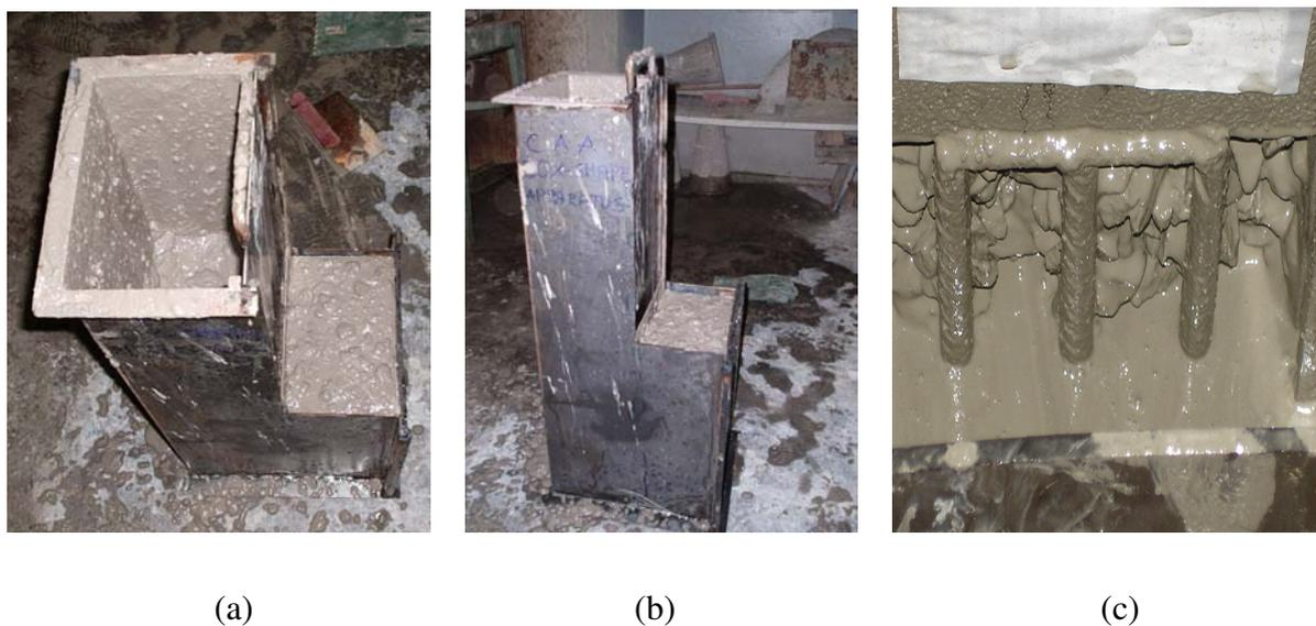
Figura 70: exemplos do comportamento do CAA durante o ensaio na *Box-shape* (a) vista superior do aparato com excelente CAA (b) vista lateral do mesmo CAA e (c) detalhe do fenômeno de bloqueio do CAA segregado ao passar por entre as armaduras
