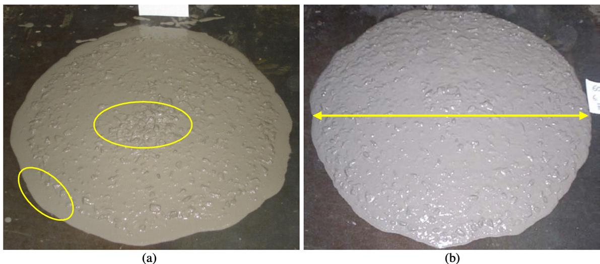
Figura 47: aspecto do CAA após o ensaio de espalhamento, onde (a) concreto segregando nas bordas e no centro e (b) concreto coeso com bom espalhamento
