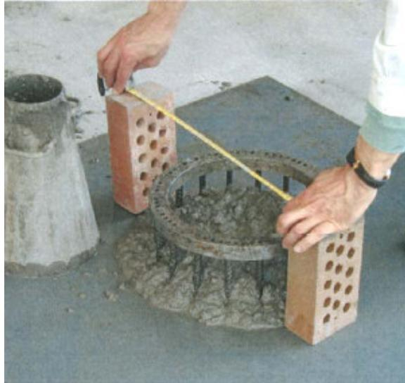
Figura 27: ensaio de espalhamento do concreto+anel japonês (Sonebi, 2004).
