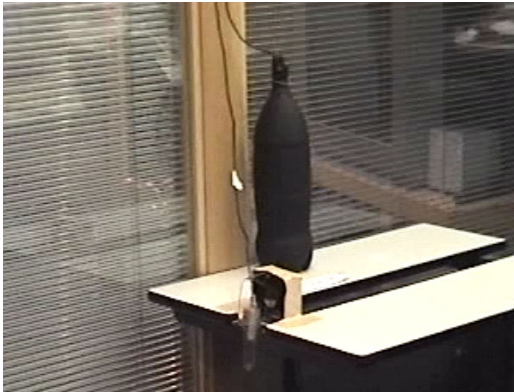
Figura 7: Equipamentos utilizados para a medição de tbu e tg .
