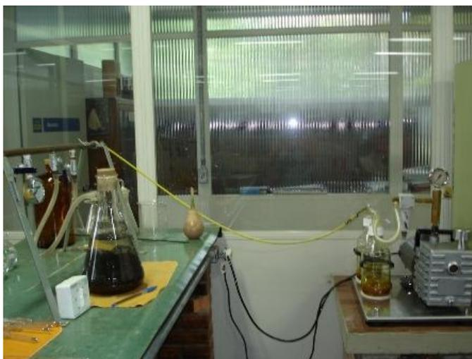
Figura 26: Equipamentos para determinação da massa específica máxima
