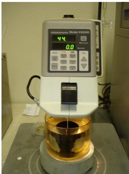
Figura 16: Penetrômetro eletrônico
