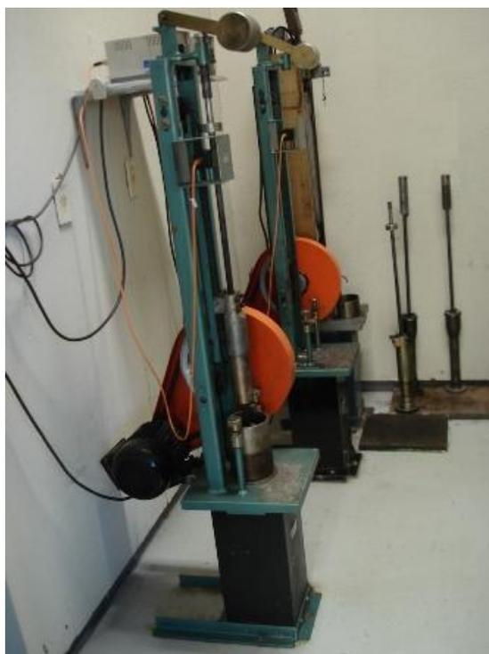
Figura 23: Compactadores mecânicos tipo Marshall
