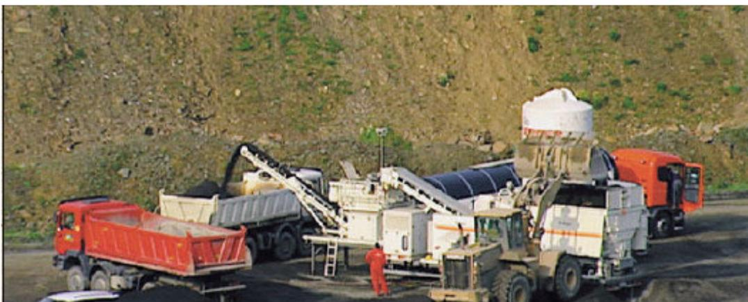
Figura 2: Reciclagem a frio em usina (Fonte: Wirtgen (2004))
