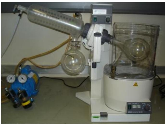
Figura 18: Rotavapor - equipamento para recuperação de asfalto
