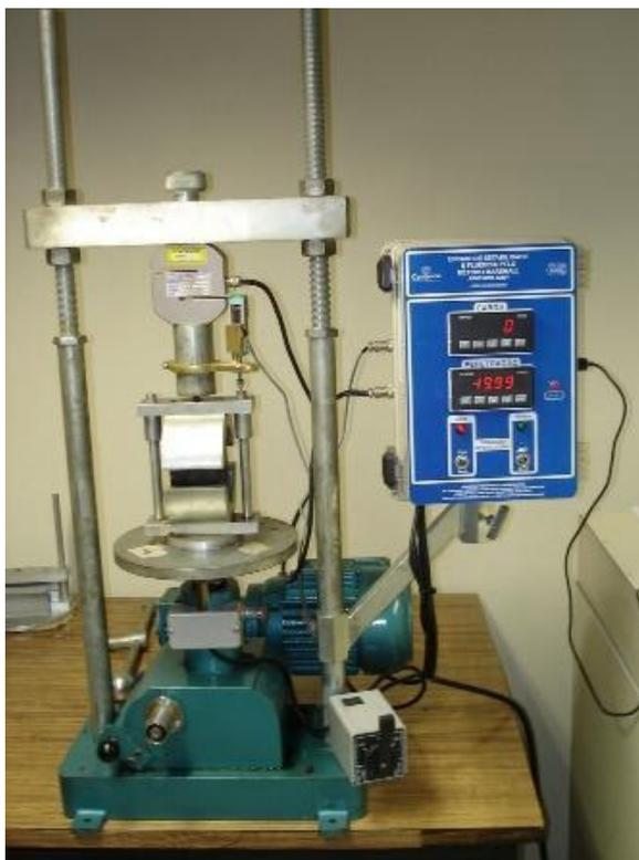
Figura 27: Prensa Marshall eletrônica
