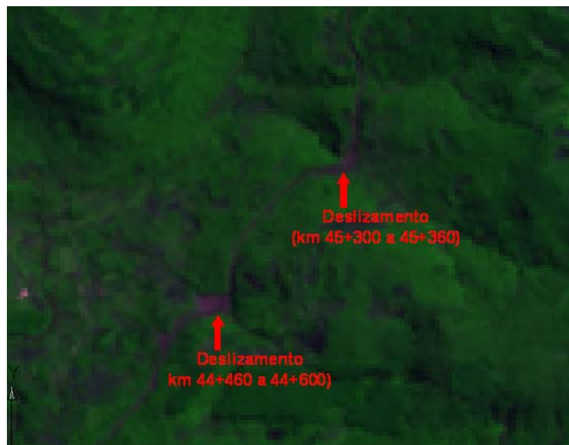
Figura 38 – Localização dos deslizamentos ao longo da RS 122, na composição colorida R2G3B1.
