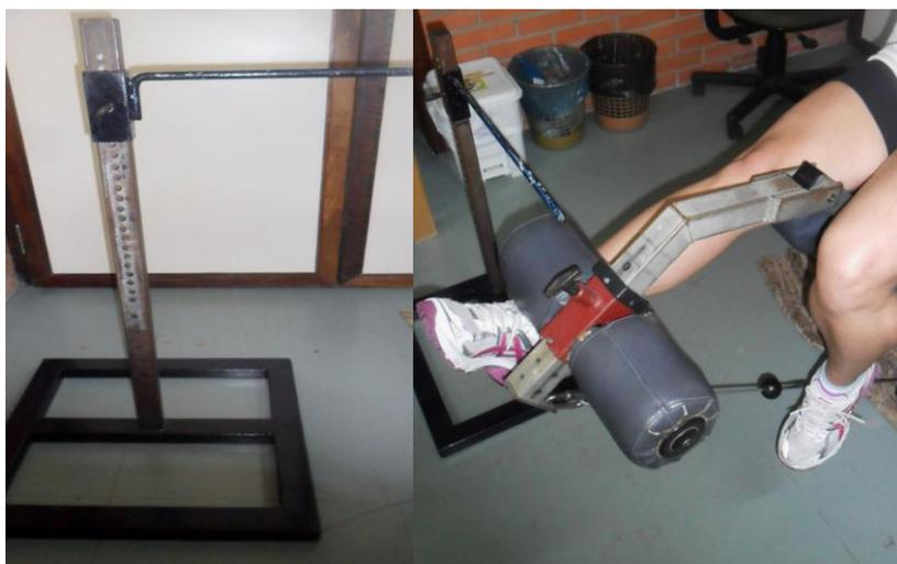
**Figura 1.** Suporte metálico para delimitar a amplitude de movimento.
