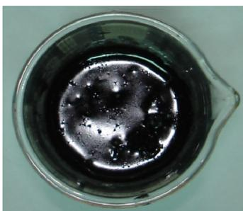
**Figura 23:** Gel obtido na síntese para uma amostra com previsão de 5 wt% de NTCMPs.
