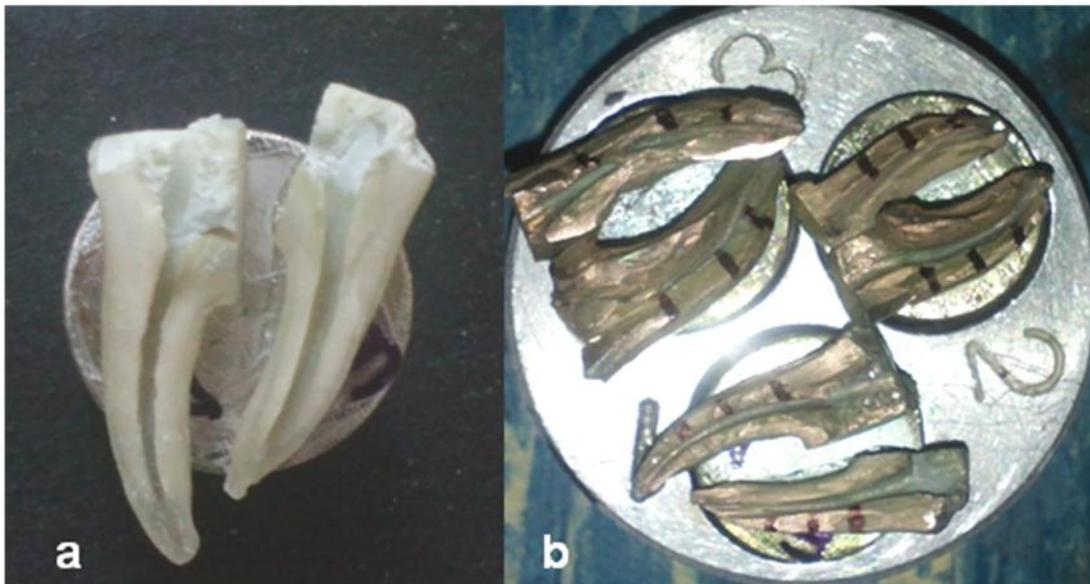
Figura 6. a) Amostras nos *stubs* e b) amostras metalizadas para análise em MEV.
