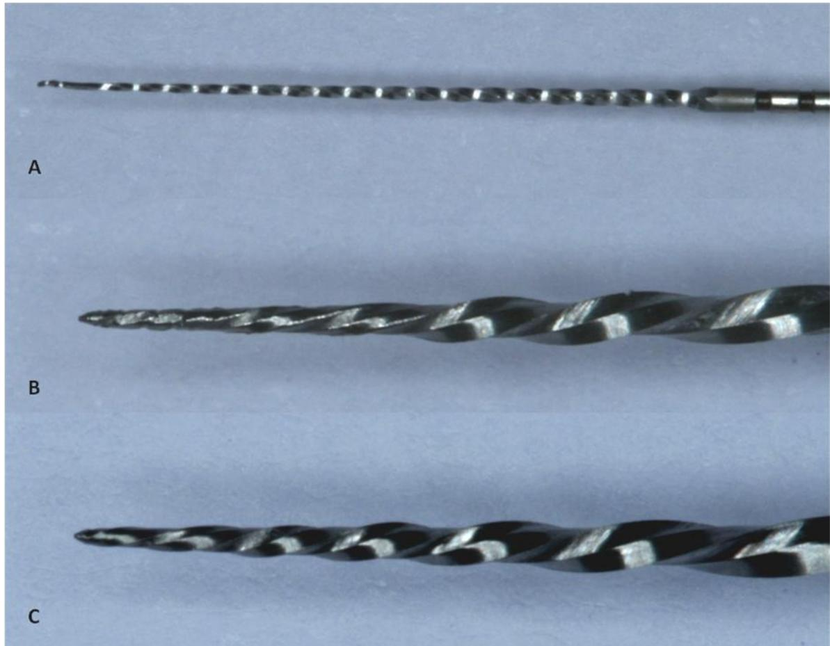
Figura 11. Fotos da deformação dos instrumentos. A - Pathfile #13, B – WaveOne usado no sistema WaveOne e C – WaveOne usado na técnica híbrida.
