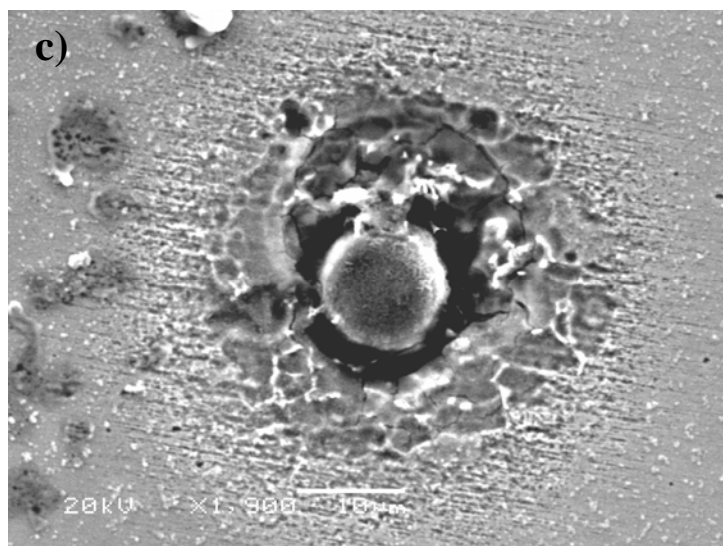
Figura 34. MEV do pite associado a inclusões do aço API 5L X56 em diferentes aumentos (a) x50, (b) x250 e (c) x1900. Amostra submetida ao extrato aquoso do solo 4 exposto a aproximadamente 3h no potencial de corrosão (imagem por elétrons secundários).
