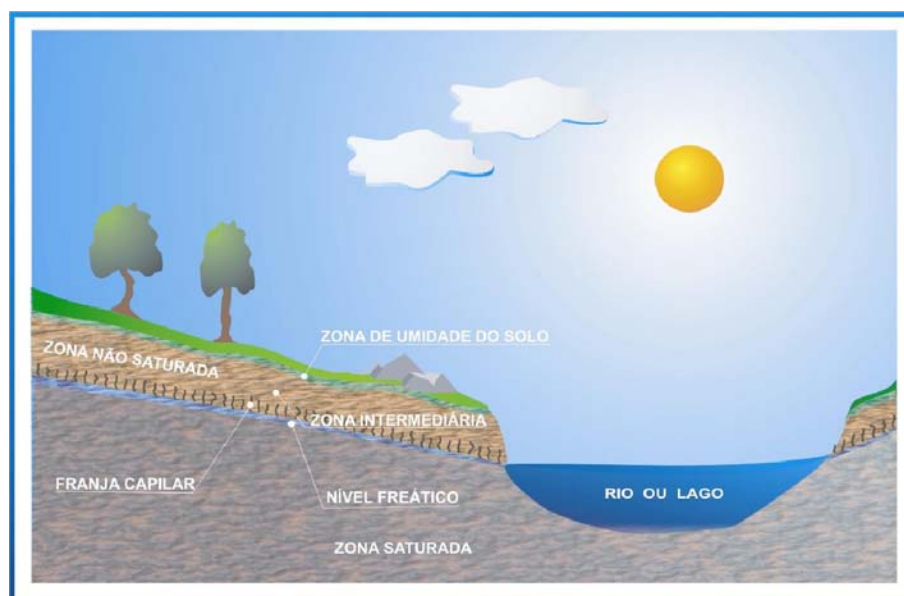
Figura 4: Modelo do posicionamento das zonas vadosa e freática em relação à superfície do terreno (sem escala, http://abas.org.br ).
