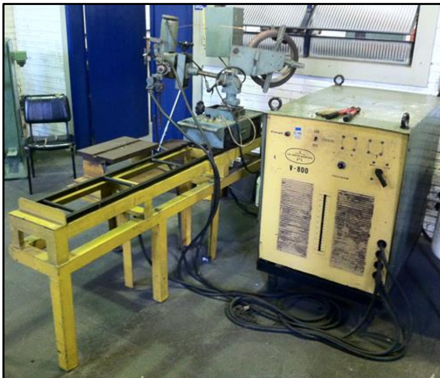
Figura 3.17 – Conjunto Unionmelt AS-800 utilizado na soldagem ao arco submerso.
