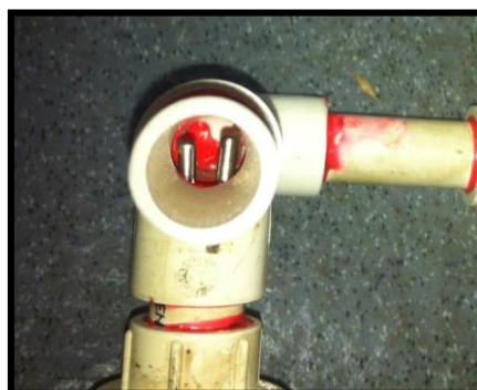
Figura 4.14 – Alinhamento da ponta dos sensores de temperatura com o centro da tubulação.
