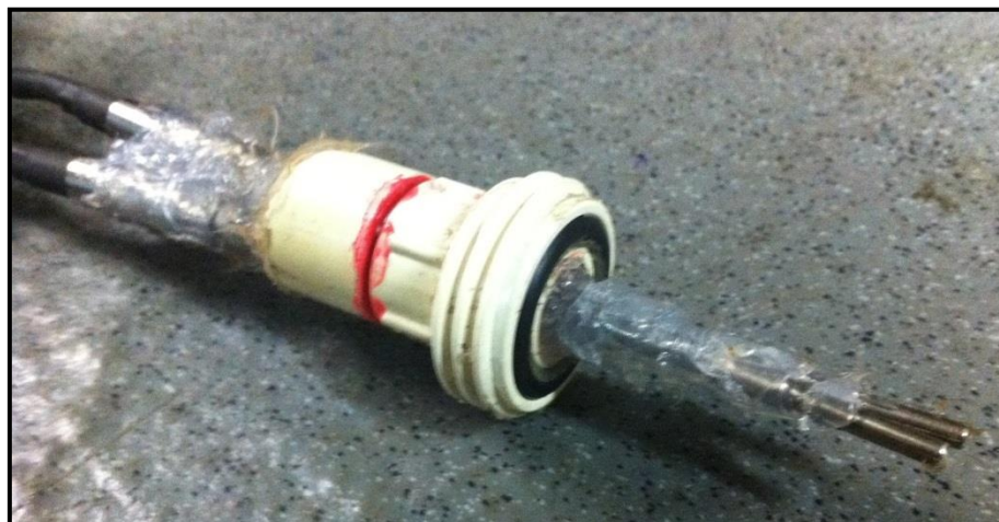
Figura 4.15 – Termopares fixos ao tampão com o uso de adesivo de silicone.
