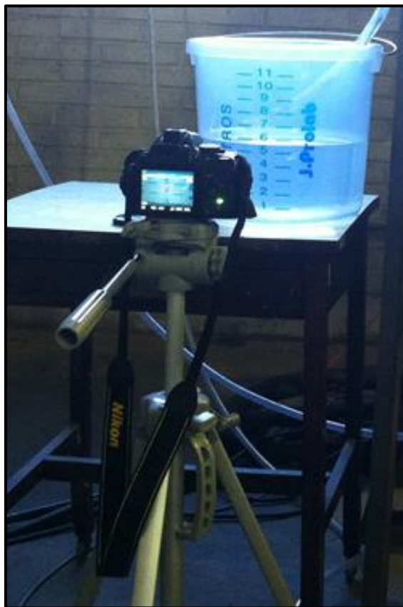
Figura 3.19 – Sistema para monitoramento da vazão de água.
