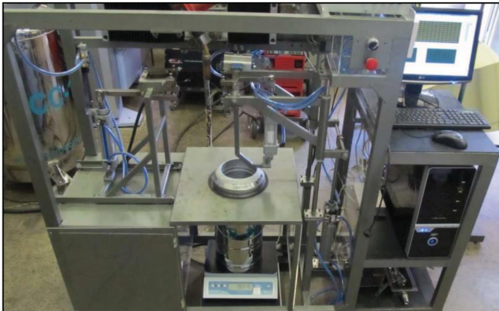
Figura 2.13 – Equipamento calorímetro de nitrogênio líquido [Fonte: Arévalo, 2011].
