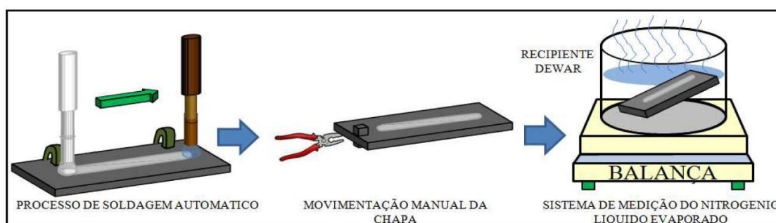
Figura 2.12 – Princípio de avaliação do aporte térmico por massa perdida de N_2L com transporte manual do corpo de prova [Fonte: Arévalo et al., 2011].
