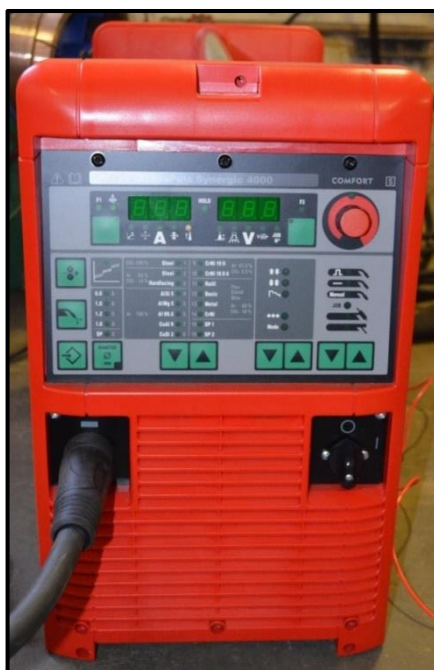
Figura 3.9 – Fonte utilizada nos processos de soldagem MIG/MAG.
