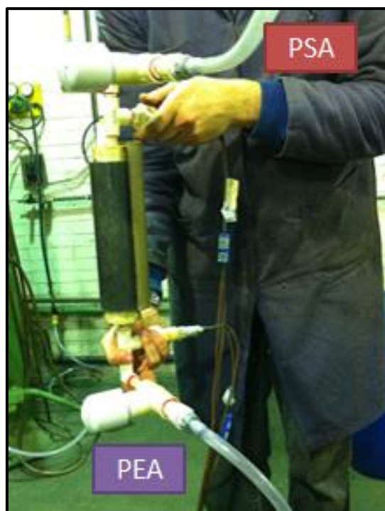
Figura 4.12 – Representação do calorímetro na posição vertical, com o ponto de entrada de água (PEA) em um nível mais baixo que o ponto de saída de água (PSA).
