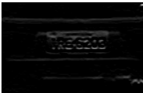
Figura 4.10: A aplicação do filtro Sobel na vertical evidencia diversos outros elementos além da placa.
