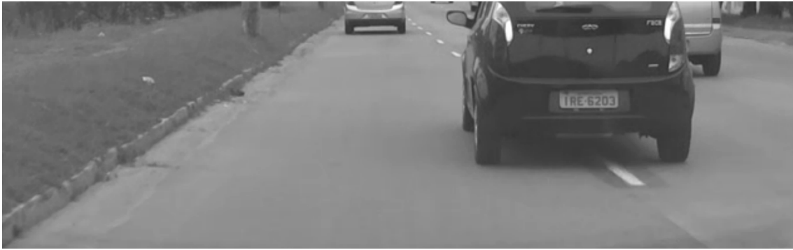
Figura 4.3: Imagem após a eliminação da região refletida pelo painel e transformação para tons de cinza.
