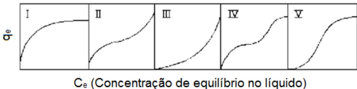
Figura 7 - Isotermas de adsorção classificadas por Brunauer *et al.* (1938)
