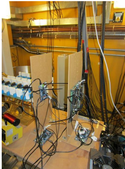
Figura 52 Experimento montado (o segundo da direita para a esquerda) na câmara de irradiação VESUVIO no ISIS. O DUT é a placa que está na vertical.
