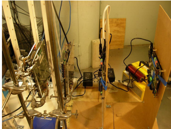
Figura 59 Experimento montado (o primeiro da direita para a esquerda) na câmara de irradiação VESUVIO no ISIS.
