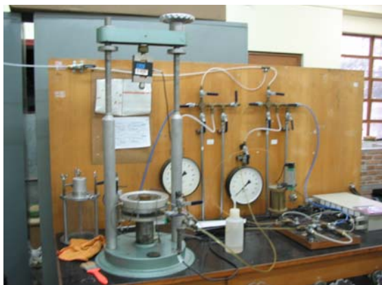
Figura 11: Prensa triaxial utilizada nos ensaios deste estudo
