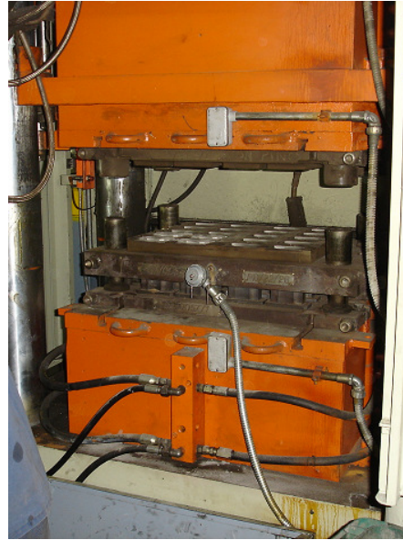
Figura 2.2.3.2 – Molde positivo multicavidades em posição aberta.
