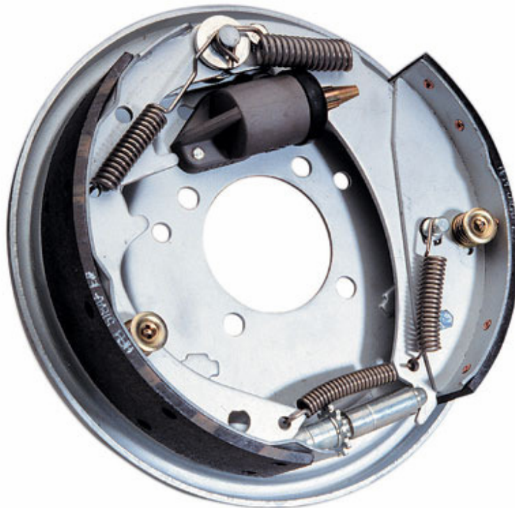
Figura 2.1.3 – Freio a tambor tipo duo-servo.
