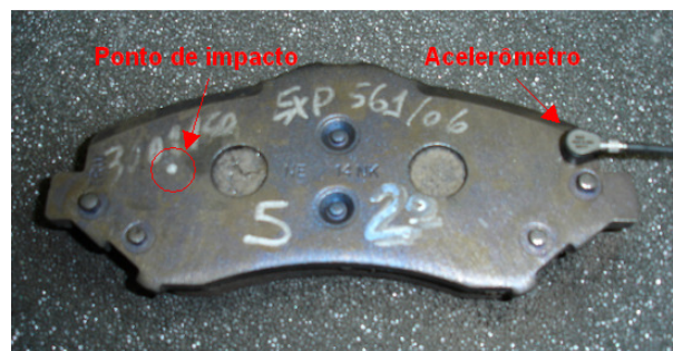
Figura 6.2.2.1 – Pontos de impacto e de fixação do transdutor na pastilha de freio.
