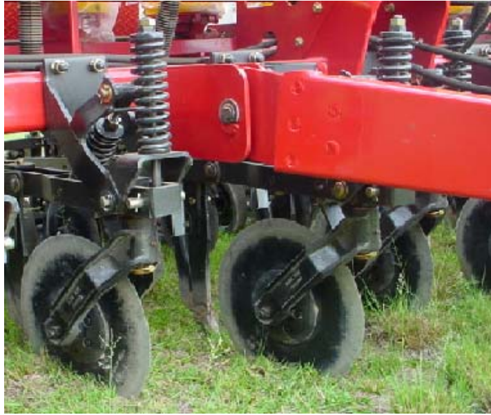
Figura 3.4 – Mecanismo de regulagem da profundidade de operação do sulcador.
