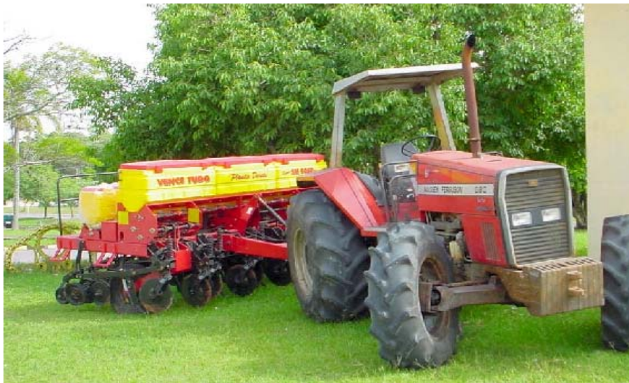
Figura 3.1 – Conjunto Trator – Semeadora - Adubadora utilizado no ensaio.
