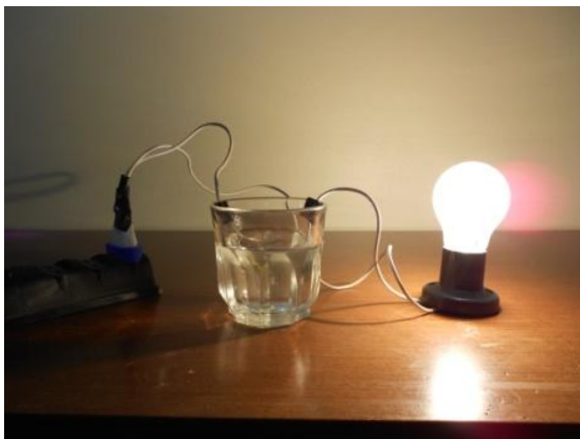
Figura 5: Montagem do equipamento utilizado para mostrar a condução elétrica através de uma solução de água e sal.
