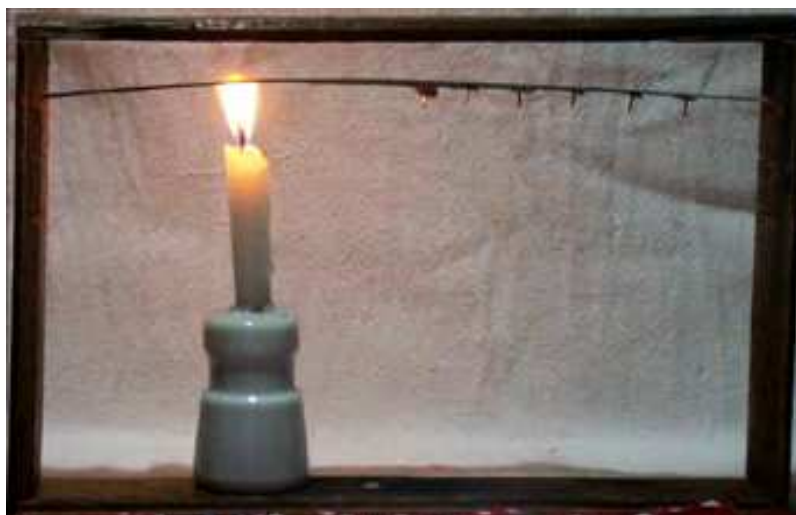
Figura 4: Demonstração sobre a condução térmica realizada na aula 4, onde a cera que segura os percevejos derrete a medida que a chapa é aquecida pela vela acesa.
