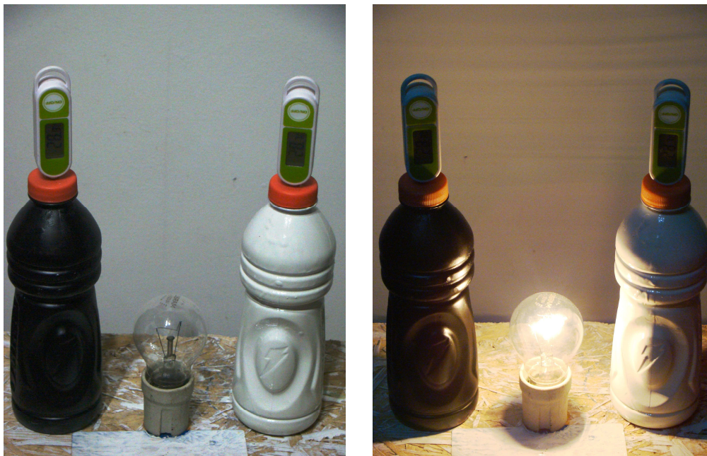
Figura 6: Demonstração sobre a capacidade térmica realizada na aula 5. Os dois termômetros estão em equilíbrio térmico com o meio, antes de a lâmpada ser acesa. Após cada garrafinha apresenta diferentes variações de temperatura.
