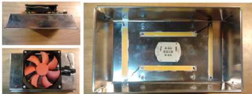
Figura 3.3 – Luminária montada, ao centro localiza-se o módulo contendo os LEDs vermelhos e azuis, e distribuídos ao longo das arestas do refletor os LEDs brancos.
