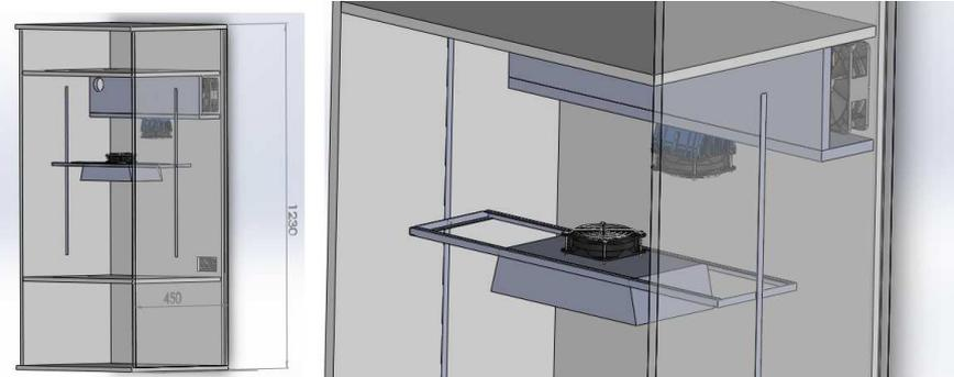
Figura 3.4 – Detalhes do sistema de fixação da luminária.
