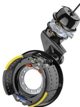
Figura 3.4: Sistema de freios utilizado em todos os eixos dos veículos analisados (Master, 2013)
