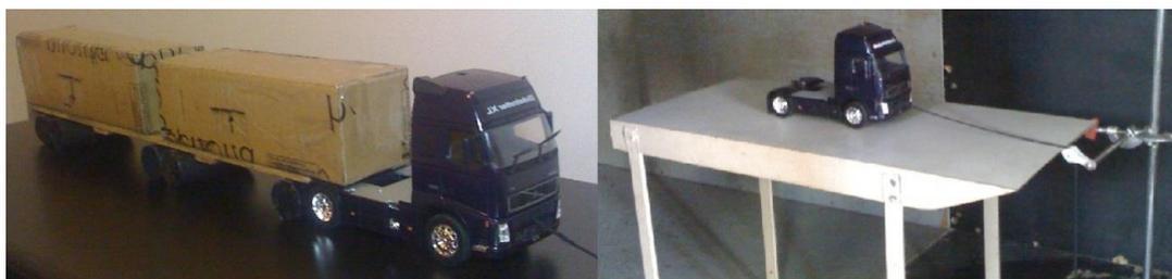
Figura 4.1: Foto do modelo e do experimento realizado no túnel de vento para determinar o Coeficiente de Atrito ( $C_d$ ).
