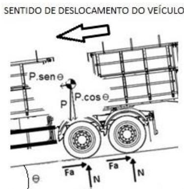
Figura 4.6: Apresentação da ampliação da figura 3.3 mostrando o diagrama de esforços envolvido na frenagem (imagem adaptada pelo autor)
