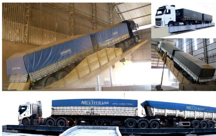
Figura 1.2: Tombadores de cargas tipo granel (veículos inclinados) e balanças rodoviárias em indústrias (veículos na horizontal) (fonte: banco de imagens Google).
