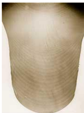
Figura 3.7 Liga de alumínio 6082 depositado em substrato de alumínio comercialmente puro, mostrando os planos de cisalhamento (THOMAS e NICHOLAS 1996).
