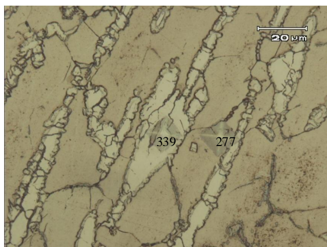
Figura 5.74 Microdureza Vickers realizada nas fases do aço inoxidável duplex em região próxima a interface com fase austenítica apresentando sinais de recristalização. Ataque eletrolítico: 60% HNO 3 40% H 2 O, 1,5V, 20 s.
