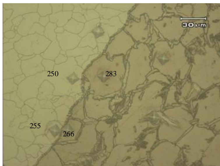
Figura 5.76 Microdurezas Vickers realizadas na interface lateral de soldagem. Ataque eletrolítico: 60% HNO 3 40% H 2 O, 1,5V, 20 s.
