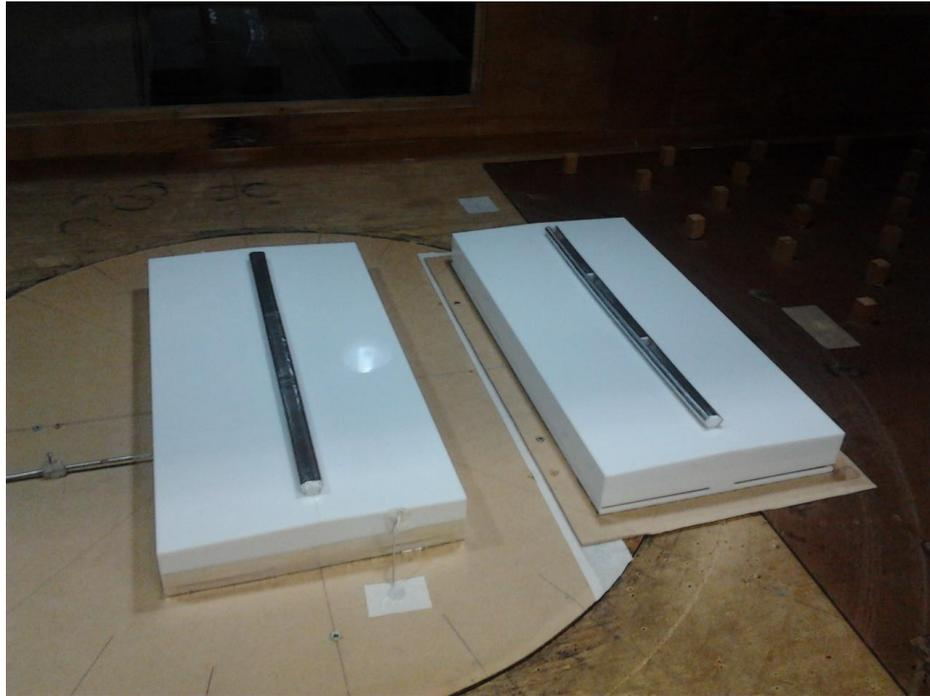
Figura 43 - Modelo instrumentado no interior do túnel.
