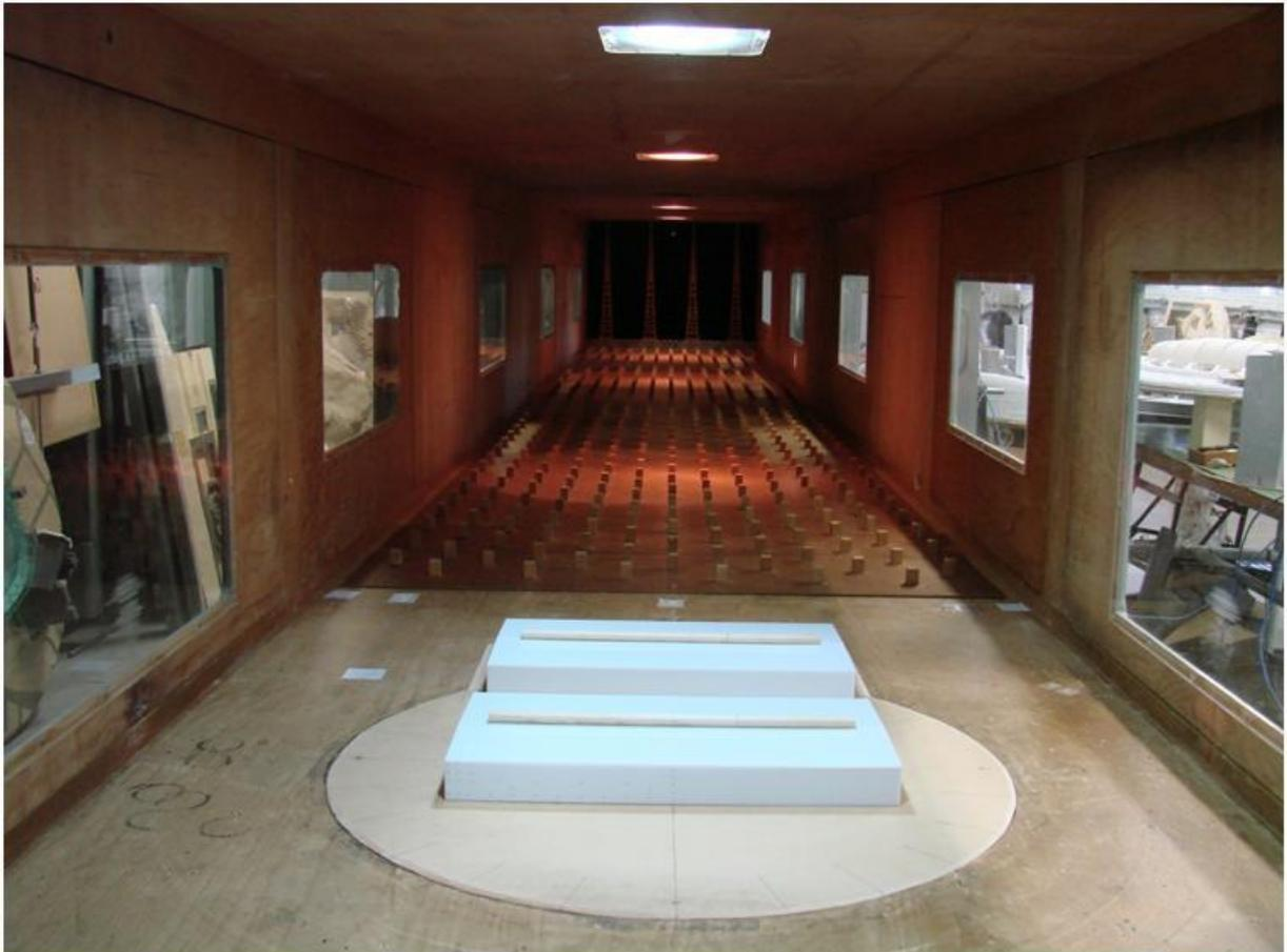
Figura 28 - Modelo inserido na Mesa II do túnel, com vizinho a uma distância  $0,5b$ .
