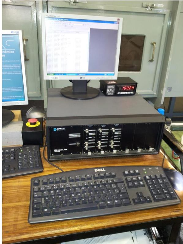
Figura 42 - Sistema de controle das sondas de fio quente.
