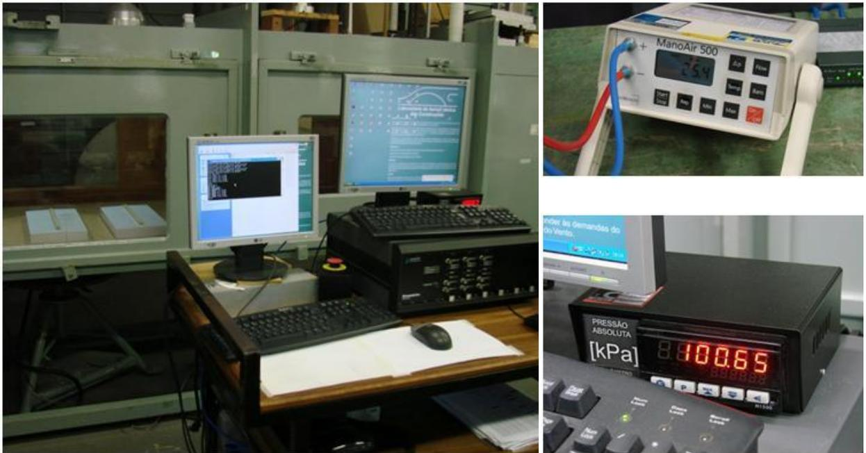
Figura 27 - Sistema de aquisição de dados dos ensaios: computador (lado esquerdo), ManoAir e barômetro.
