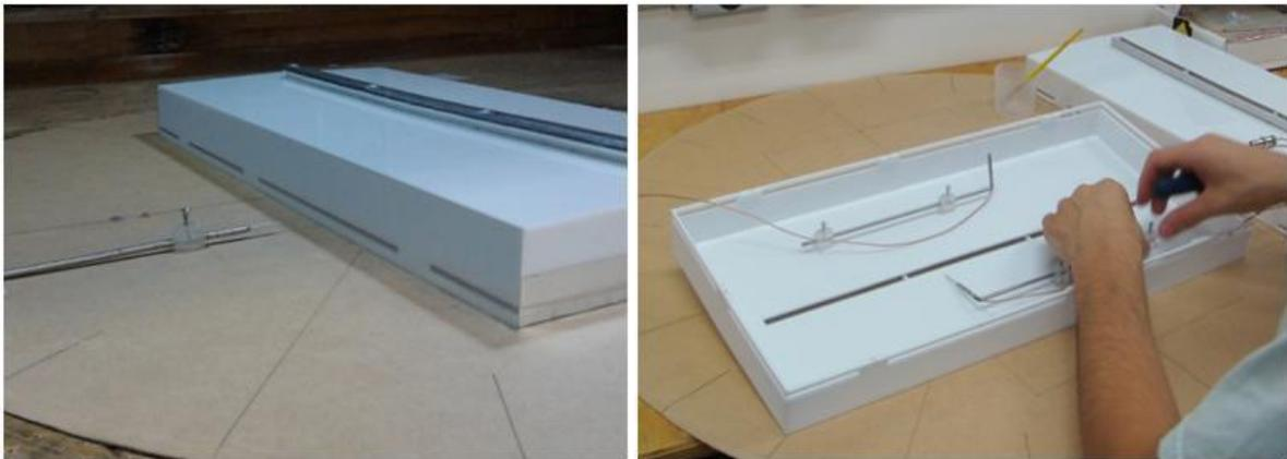
Figura 37 - Posicionamento e fixação das sondas no modelo.
