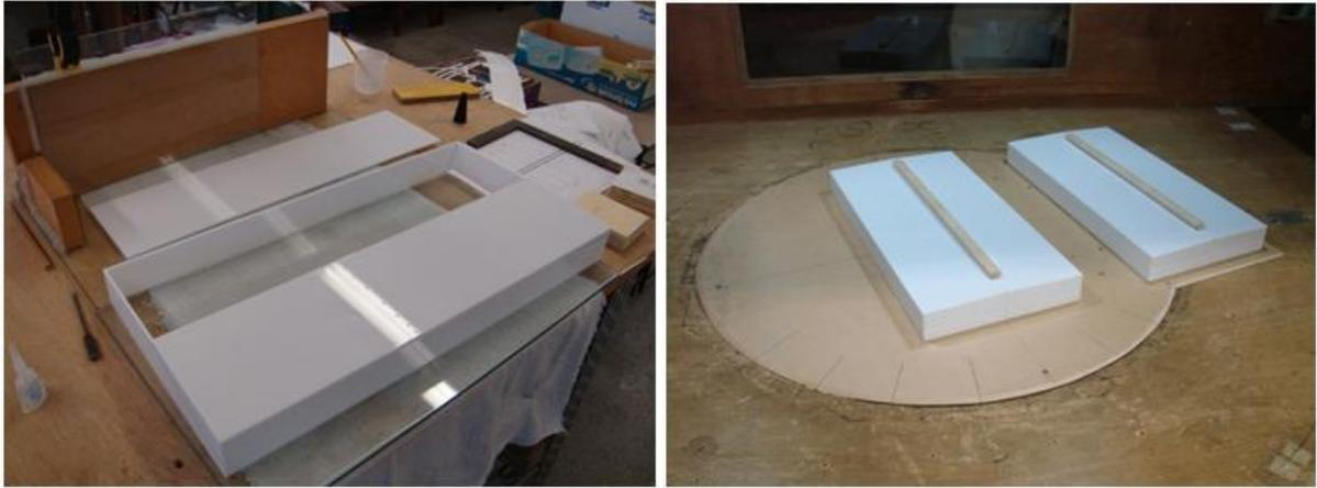
Figura 25 - Detalhe da montagem do modelo e na mesa de ensaio, com modelo vizinho.
