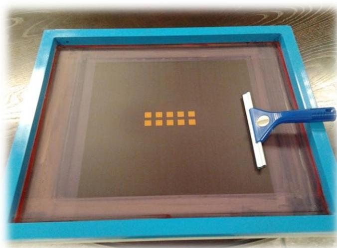
**Figura 5.34:** Tela de serigrafia usada para a impressão do eletrodo de ZnO biomimético.
