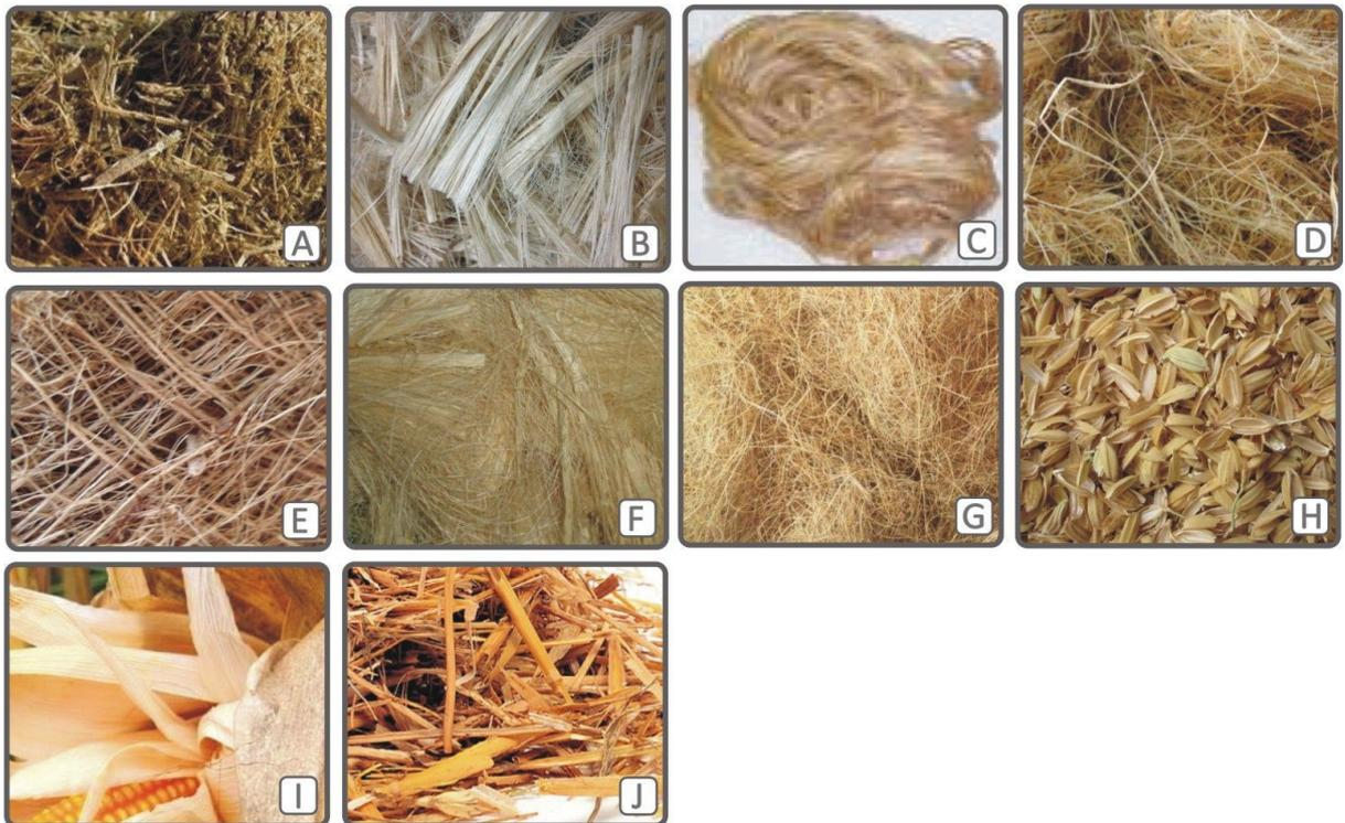
Figura 32: Fibras brasileiras utilizadas no desenvolvimento de compósitos biodegradáveis: A) fibra de bagaço de cana-de-açúcar, B) fibra de juta, C) fibra de curauá, D) fibra de bananeira, E) fibra de carnaúba, F) fibra de sisal, G) fibra de coco, H) palha de arroz, I) palha de milho e J) palha de trigo. Fonte: Google imagens (2013).
