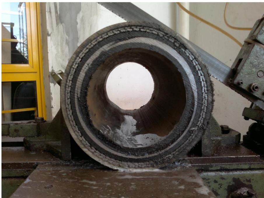
Figura 3.11: Dissecação da amostra de seis polegadas de diâmetro do tipo não aderente de parede lisa.
