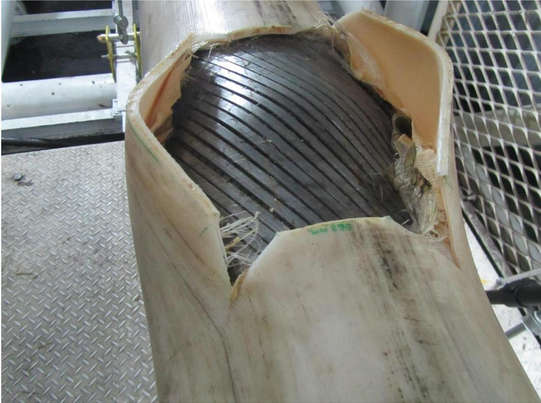
Figura 4.11: Condição da amostra no final do teste 3.
