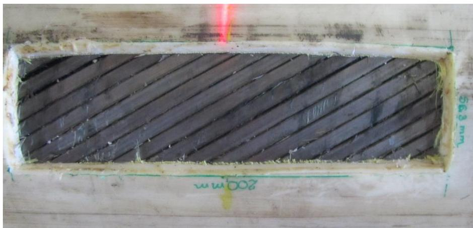
Figura 3.9: Bandagens de alta resistência removidas (fita anti-birdcaging).
