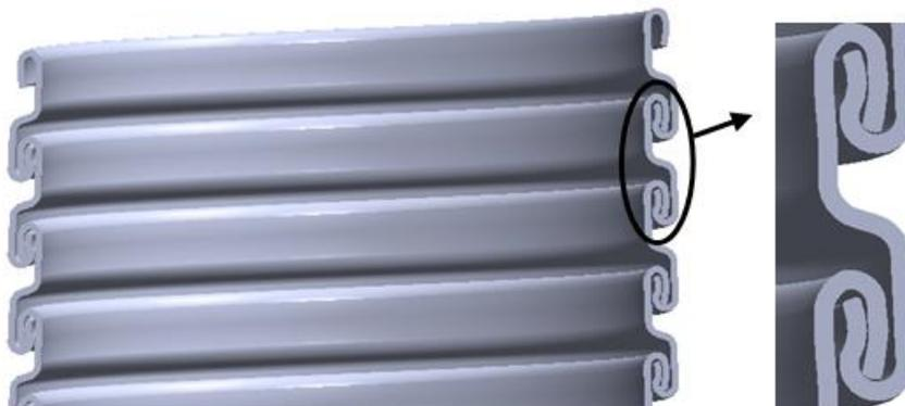
Figura 2.5: Geometria básica da carcaça intertravada com detalhe do perfil intertravado.
