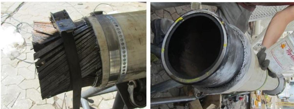
Figura 3.4: Cortes dos arames e capa externa antes(esquerda) e depois(direita).
