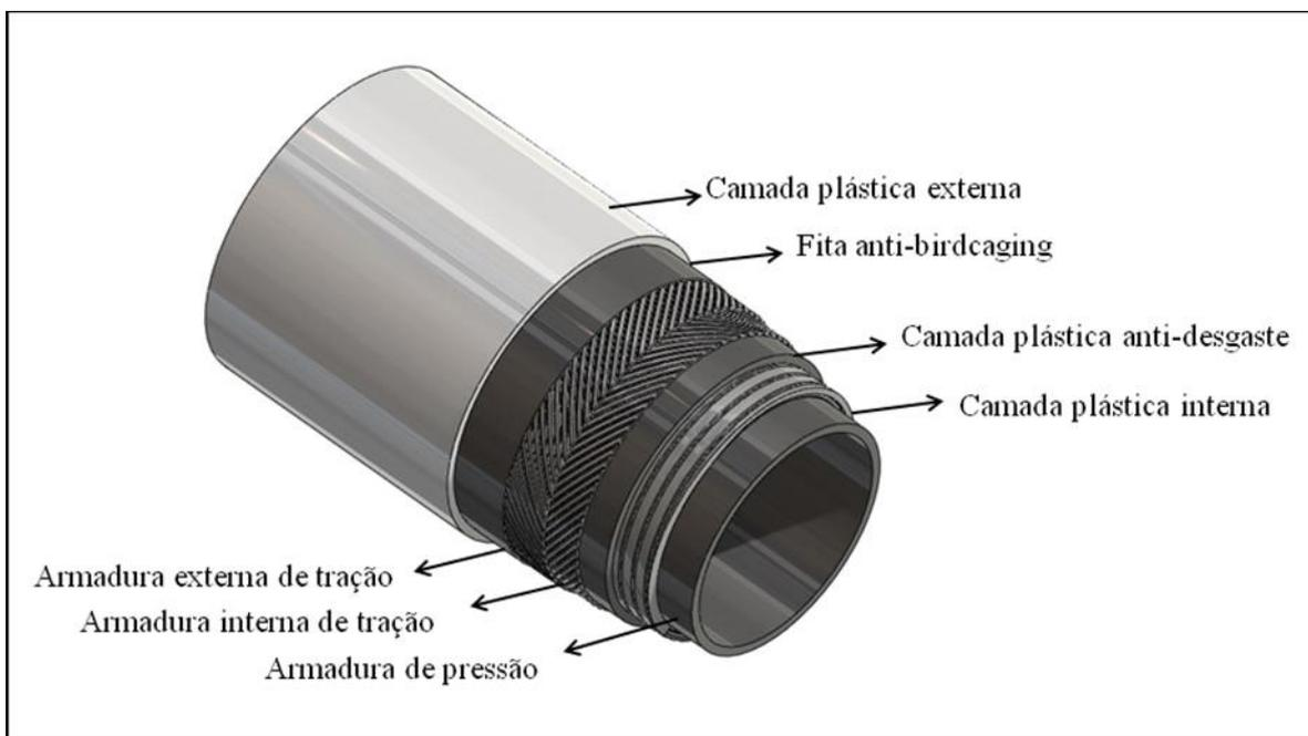
Figura 2.4: Detalhamento das camadas de um duto com parede lisa.
