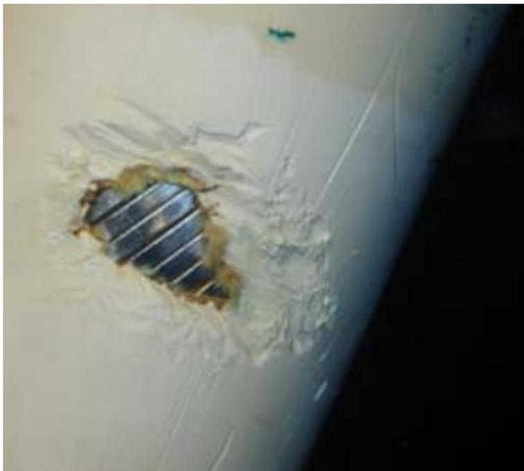
Figura 2.14: Defeito na bandagem de alta resistência gerado na instalação da linha flexível (PICKSLEY 2002).
