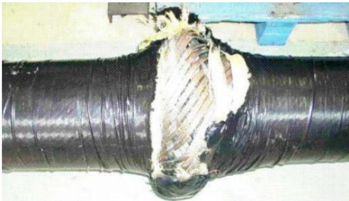
Figura 2.1: Aspecto dos arames da armadura de tração de uma linha flexível na falha por formação de "gaiola de passarinho" (BECTARTE & COUTAREL, 2004).
