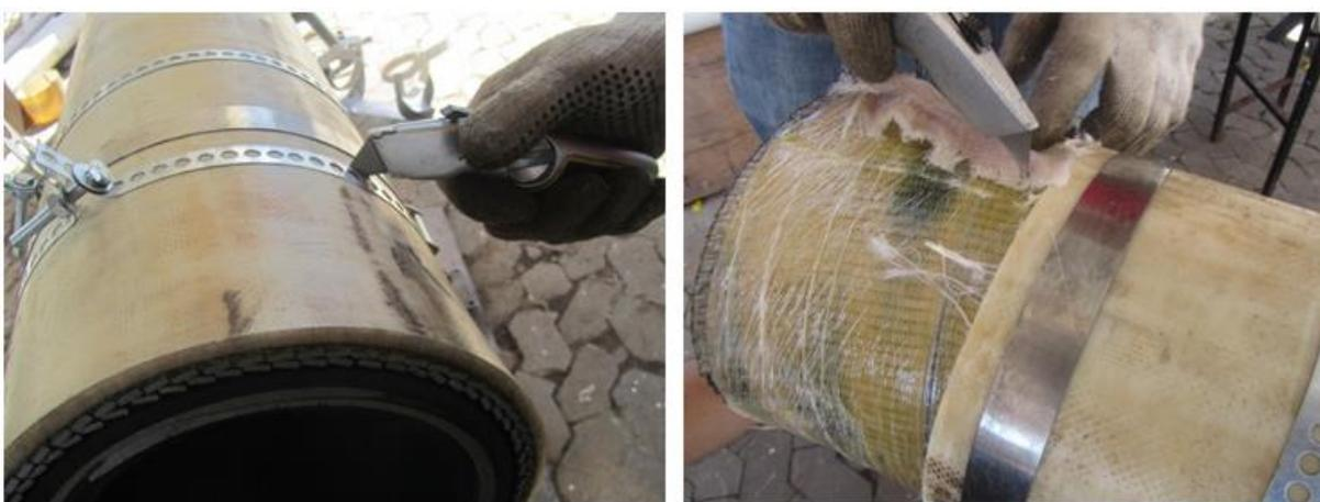
Figura 3.3: Cortes da capa externa (esquerda) e bandagem de alta resistência (direita).
