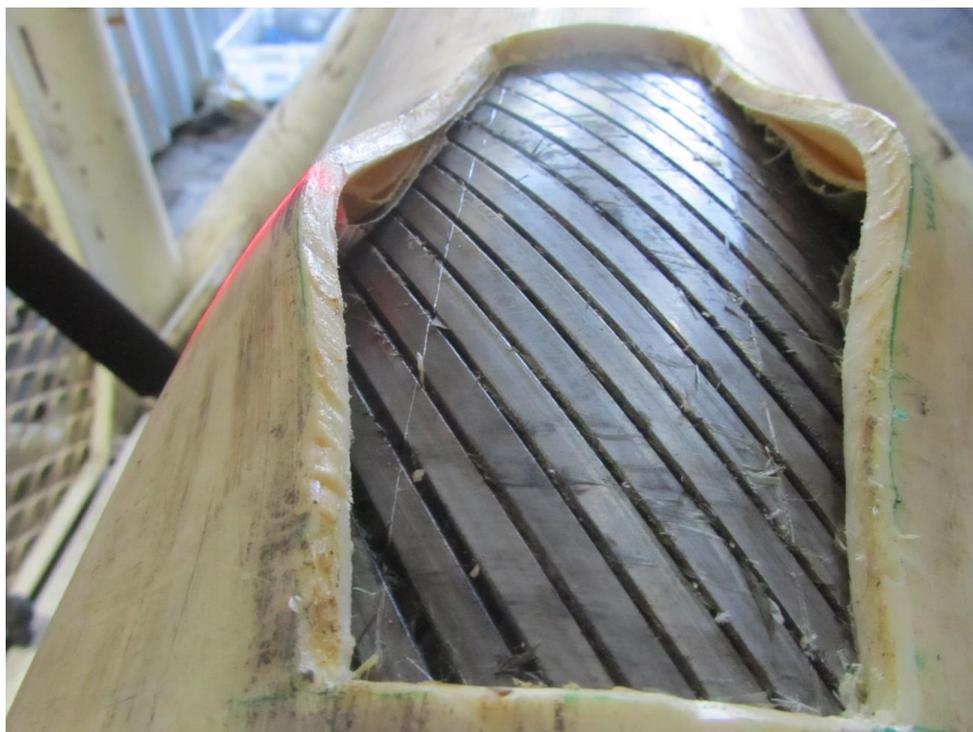
Figura 4.5: Enrugamento da capa e expansão da armadura de arames na região central, antes dos testes 3 e 4.
