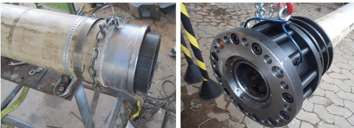
Figura 3.5: Inserção da cunha metálica (esquerda) e montagem do conjunto(direita).
