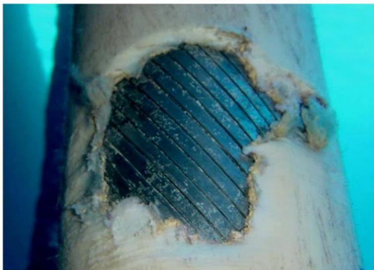
Figura 2.15: Defeito na bandagem de alta resistência devido ao contato com a plataforma durante operação ou instalação do riser (CARNEVAL, MARINHO, 2006).
