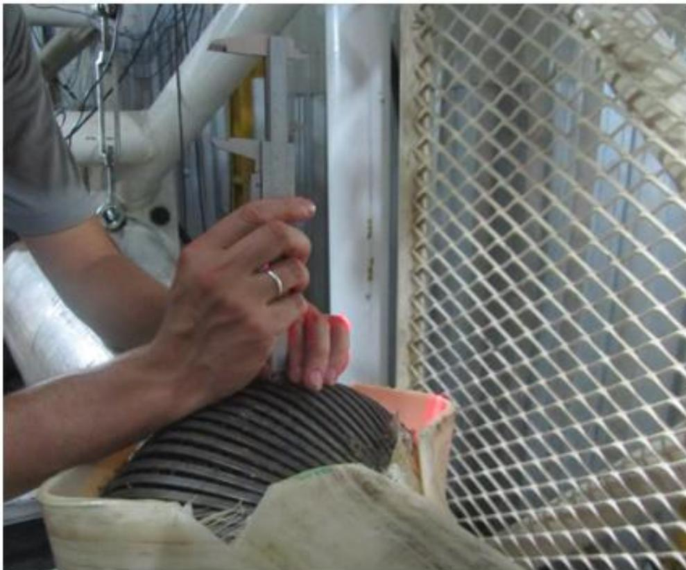
Figura 4.9: Medição da altura radial da gaiola de passarinho, teste 3.
