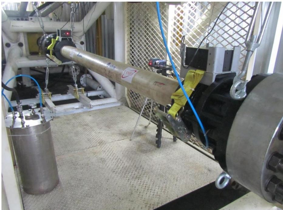
Figura 3.7: Configuração utilizada no teste de compressão.
