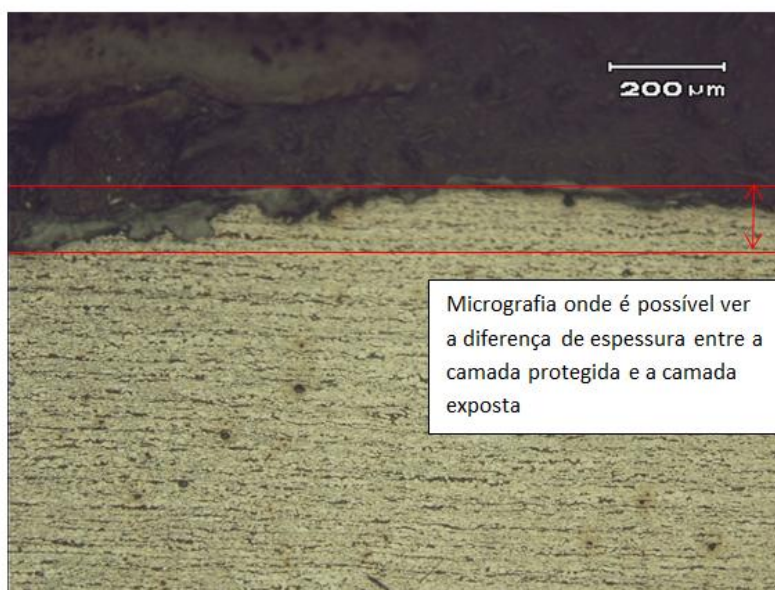
Figura B: Micrografia com 100 vezes de aumento na divisa (entre a camada protegida e a camada exposta)
