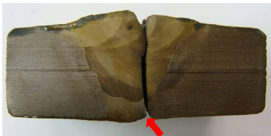
Figura 5.9: Perfil da fratura do corpo de prova 34 (a seta aponta o início da trinca)
