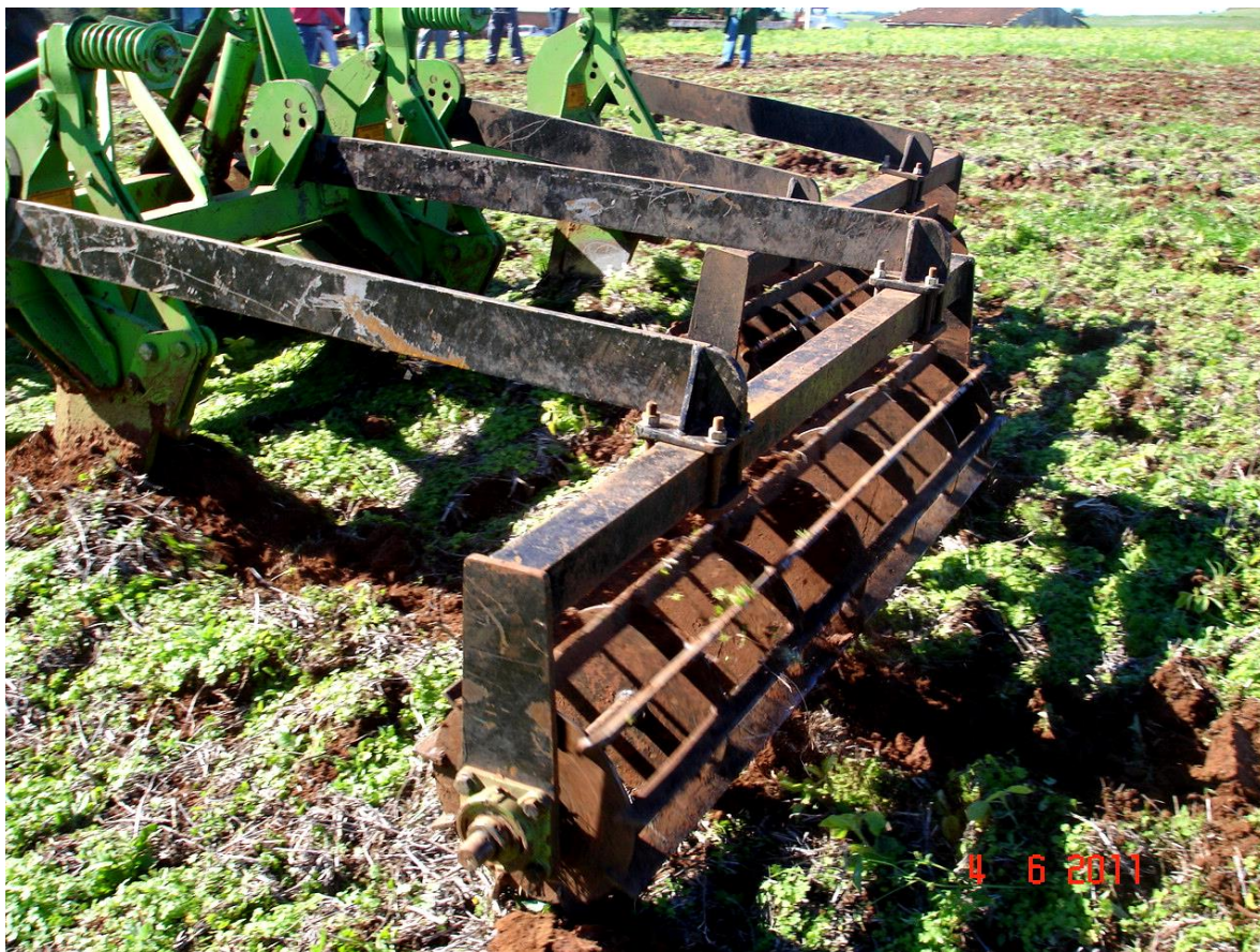
Figura 10 - Equipamento Fox, descompactando o solo de lavoura.
