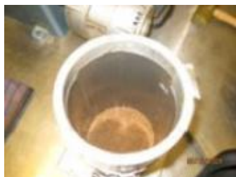
1. Primeira camada compactada e escarificada
