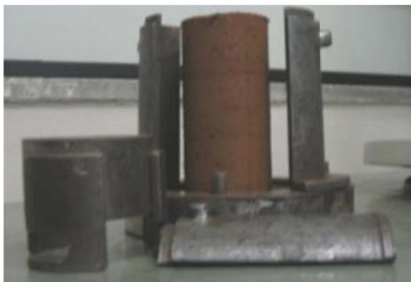
Figura 4.6. Corpo de prova moldado na forma remoldada em um molde tripartido
