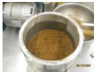
2. Quinta camada compactada e escarificada
