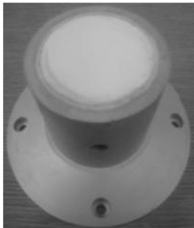
Figura 3.3. Disco cerâmico de alto valor de entrada de ar utilizado para ensaios na condição não saturada no HCA
