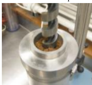
5. Execução da cavidade com broca de menor diâmetro
