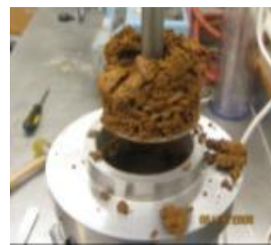
8. Execução da cavidade no seu diâmetro final
