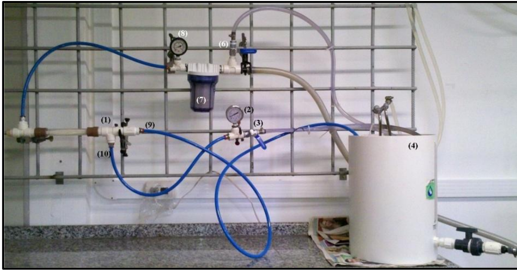
Figura 3.5: Fotografia do sistema de bancada de MF, onde: módulo da membrana (1); manômetros (2) e (8); válvula esfera (3) e (6); tanque (4); bomba centrífuga (5); pré-filtro (7); recipiente para coleta de permeado (9); corrente de concentrado (10) e banho termostático (11).
