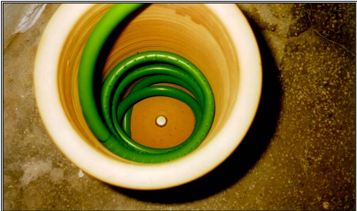
Figura 4.7 – Detalhe da mangueira de injeção de ar nos vasos cerâmicos ( Fase 3 e 4 )
