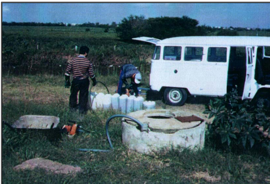
Figura 4.2 – Detalhe da coleta de lixiviado no Aterro Sanitário Zona Norte
