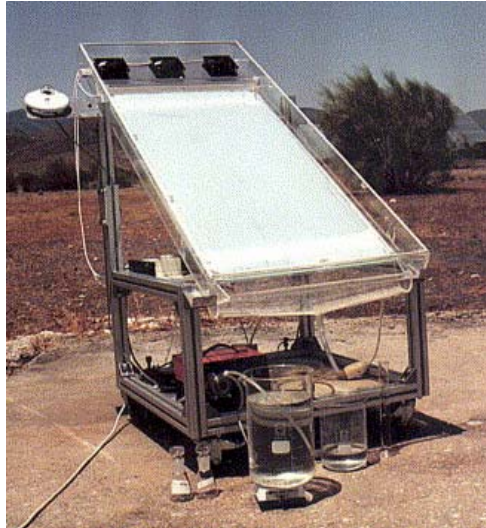
Figura 2.7: Instalação experimental de um reator de placa plana na Plataforma Solar de Almería na Espanha. Fonte: Adaptado de Bahnemann, 2004.
