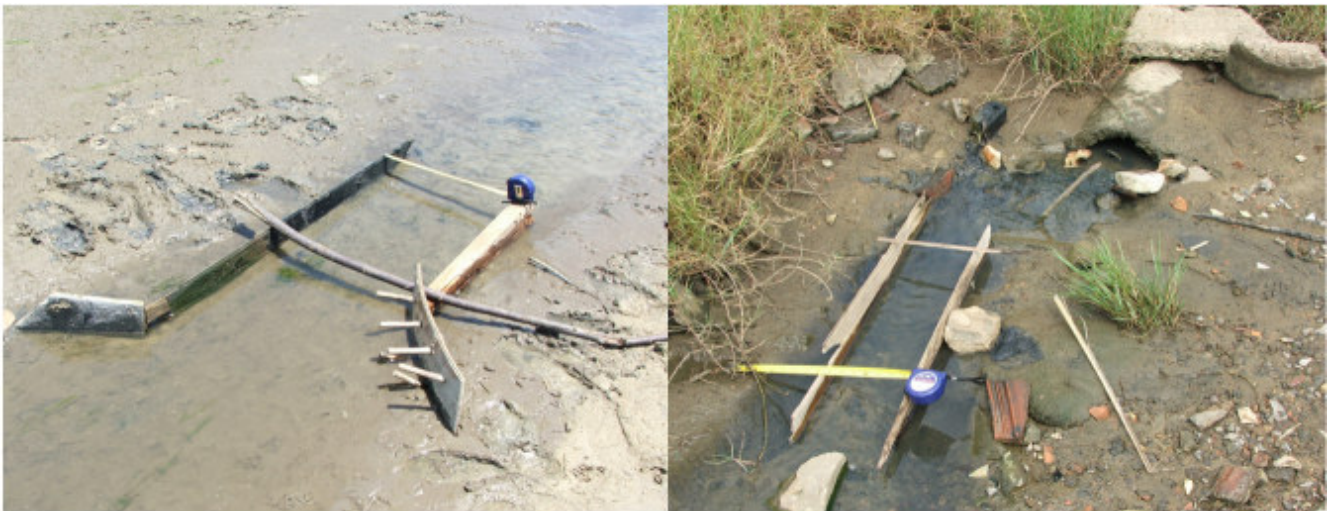
Figura 3.6: Exemplos ilustrando os tipos de estruturas por vezes utilizadas nas canaletas a céu aberto das redes de drenagem pluvial dos municípios de Tramandaí e Imbé para garantir as condições de largura e profundidade constantes e para delimitar a distância de cronometragem da parcela de água.
