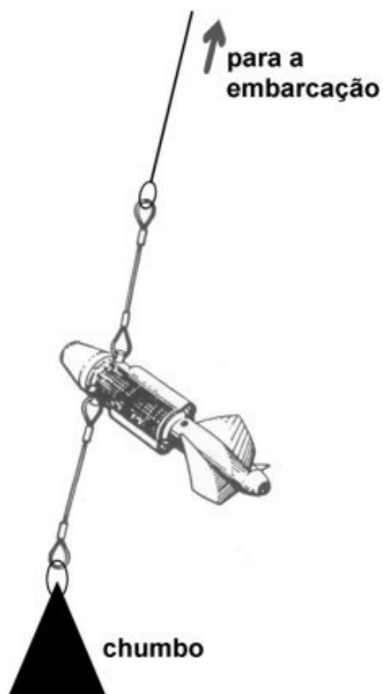
Figura 2.2: Desenho esquemático da montagem do fluxômetro no cabo para efetuar as medições de velocidade da corrente.
