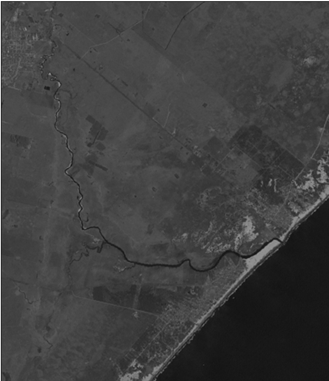
Fig. 6 - Imagem obtida no dia 31/12/2000 pelo sensor ETM+ banda 7 do satélite Land-Sat 7, com resolução de 15 m por pixel, georeferenciada e ortoretificada. Observa-se a desembocadura fixa por molhes.
