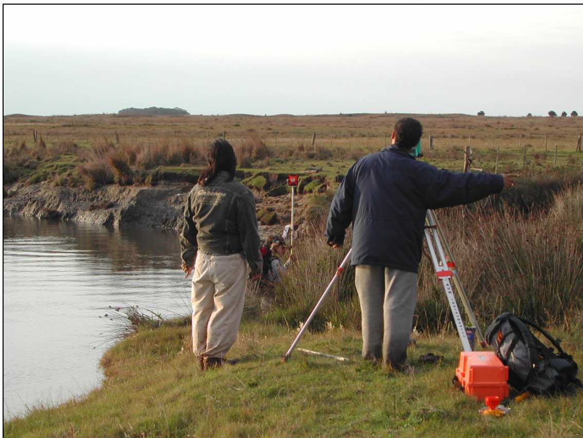
Fig. 8 – Uso de estação total e mira a laser no levantamento do perfil topográfico P2. No local, o Arroio Chuí erode depósitos holocênicos fossilíferos (Afloramento 1).
