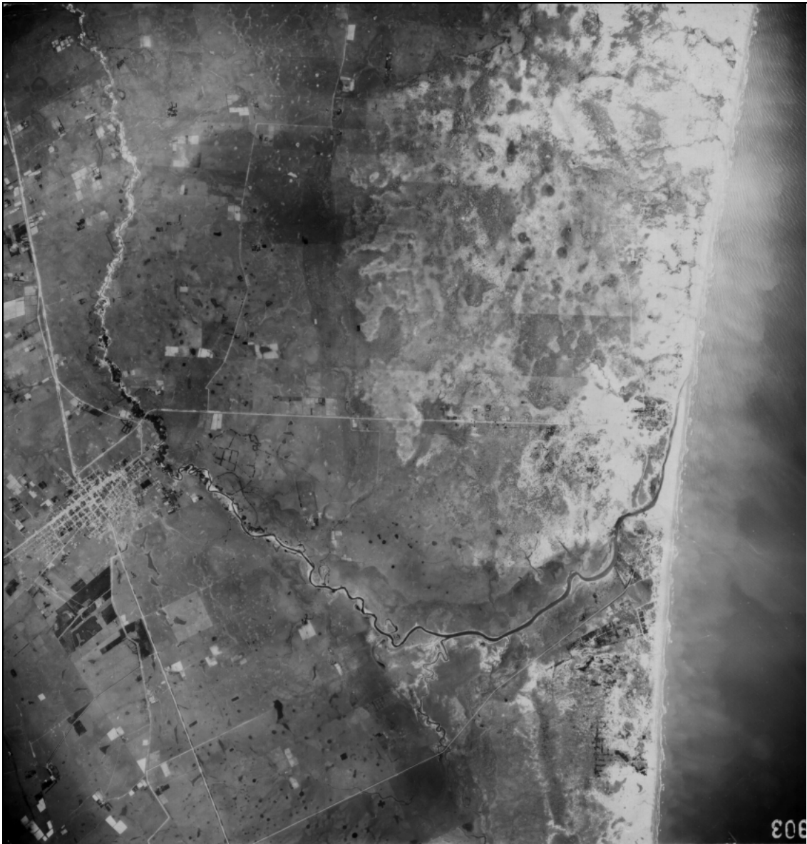
Fig. 5 - Fotografia aérea vertical, do ano de 1966, escala 1:60.000, gerada pelo Exército Brasileiro. Anterior à construção dos molhes da barra do Chuí (1975), percebe-se claramente o canal migrando no sentido NE, acompanhando o sentido dominante da deriva litorânea. Adjacente ao canal atual são evidentes os limites altimétricos entre terrenos mais baixos (escuros) holocênicos e terrenos mais elevados (claros) representados pela barreira pleistocênica.
