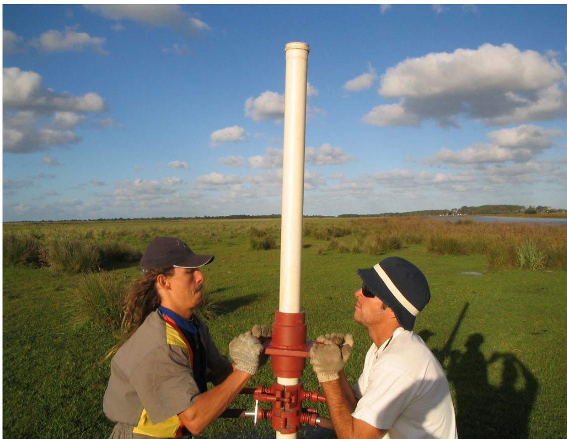
Fig. 12 – Processo de Testemunhagem a Percussão com o uso de tubo de PVC (fase de penetração do testemunho).
