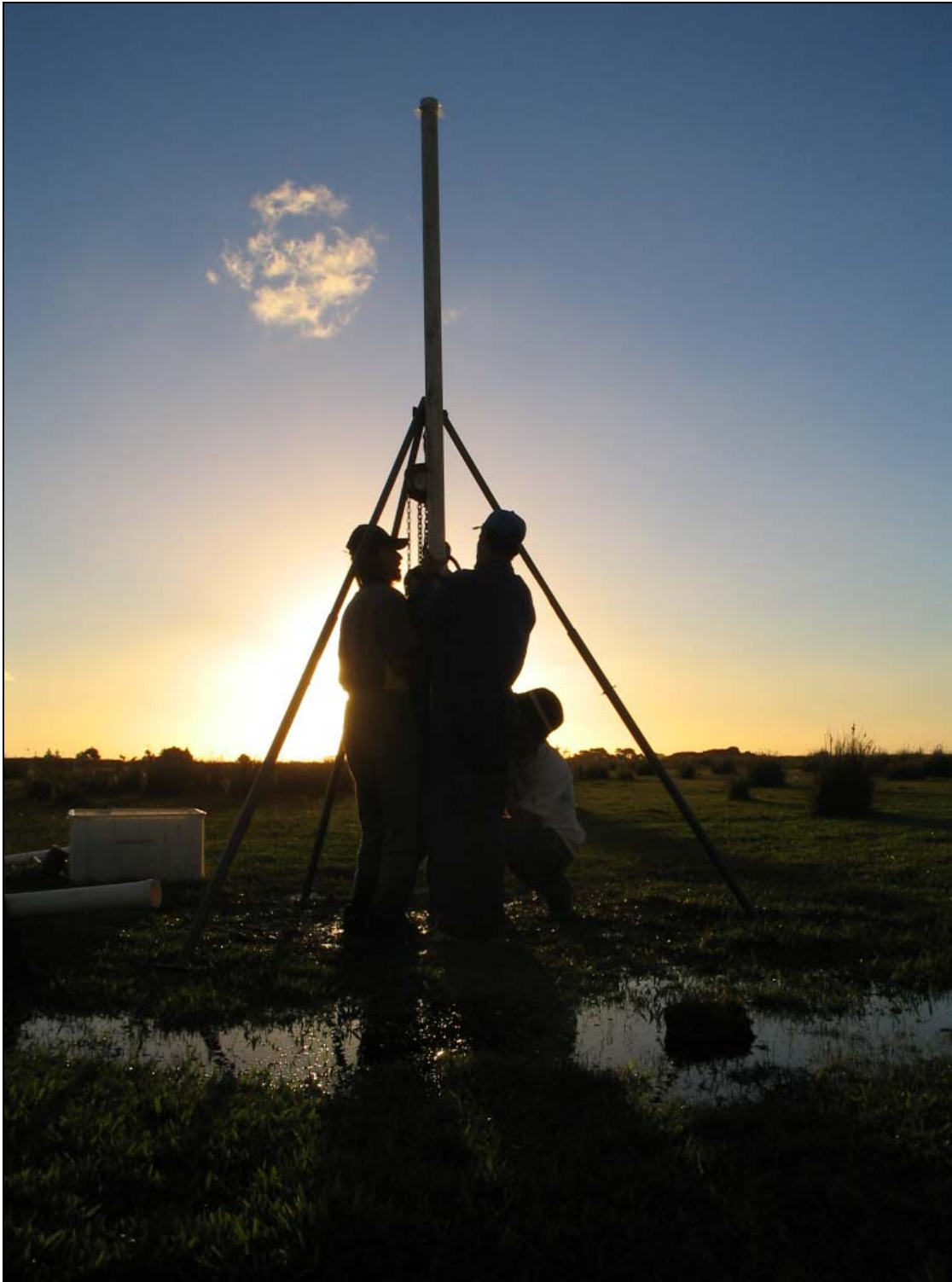
Fig. 13 – Processo de Testemunhagem a Percussão (fase de retirada do testemunho).
