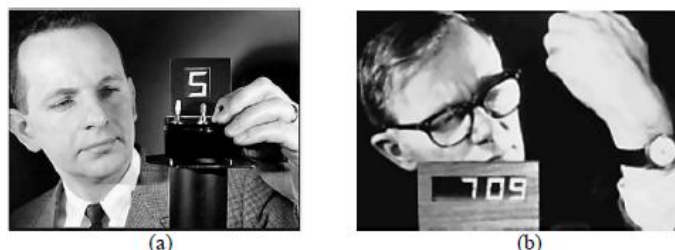
Figura 4. Protótipos da RCA (a) Heilmeyer mostrando o primeiro LCD. (b) O primeiro relógio digital de LCD. 24
