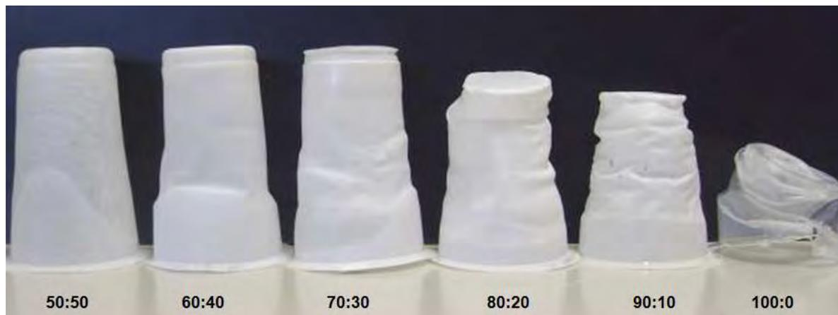
Figura 68: Copos termoformados com diferentes percentuais de PLLA:HIPS após teste com água a 80°C durante 2 minutos
