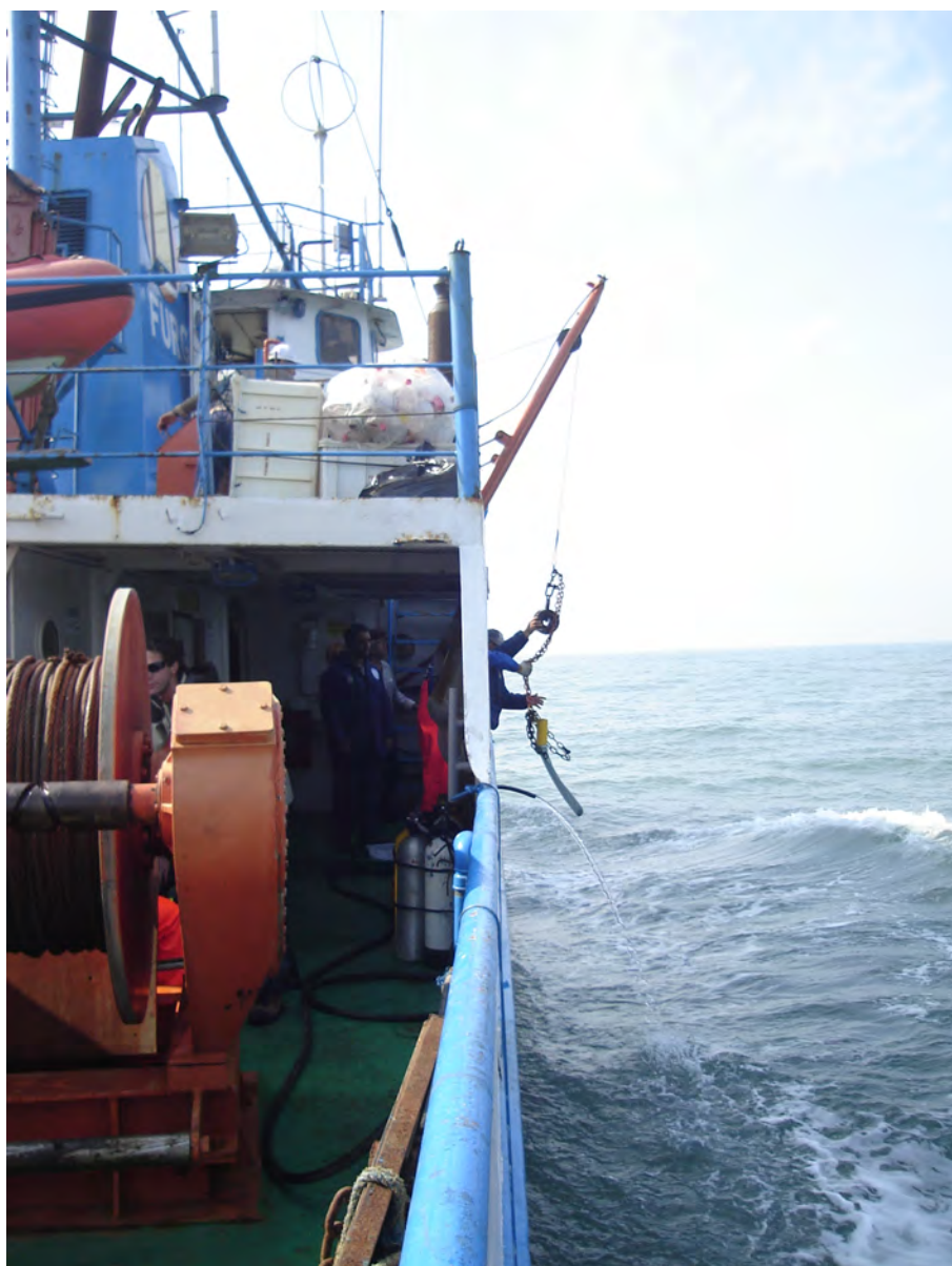
Figura 5: Foto da vista boreste do navio Oceanográfico Atlântico Sul - FURG realizando a amostragem de fundo. Na porção externa da embarcação a draga Gibbs e lastro sendo operada pelo gincho oceanográfico.
