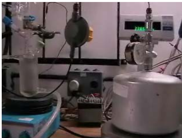
Figura 14. Montagem do reator para os testes catalíticos.
