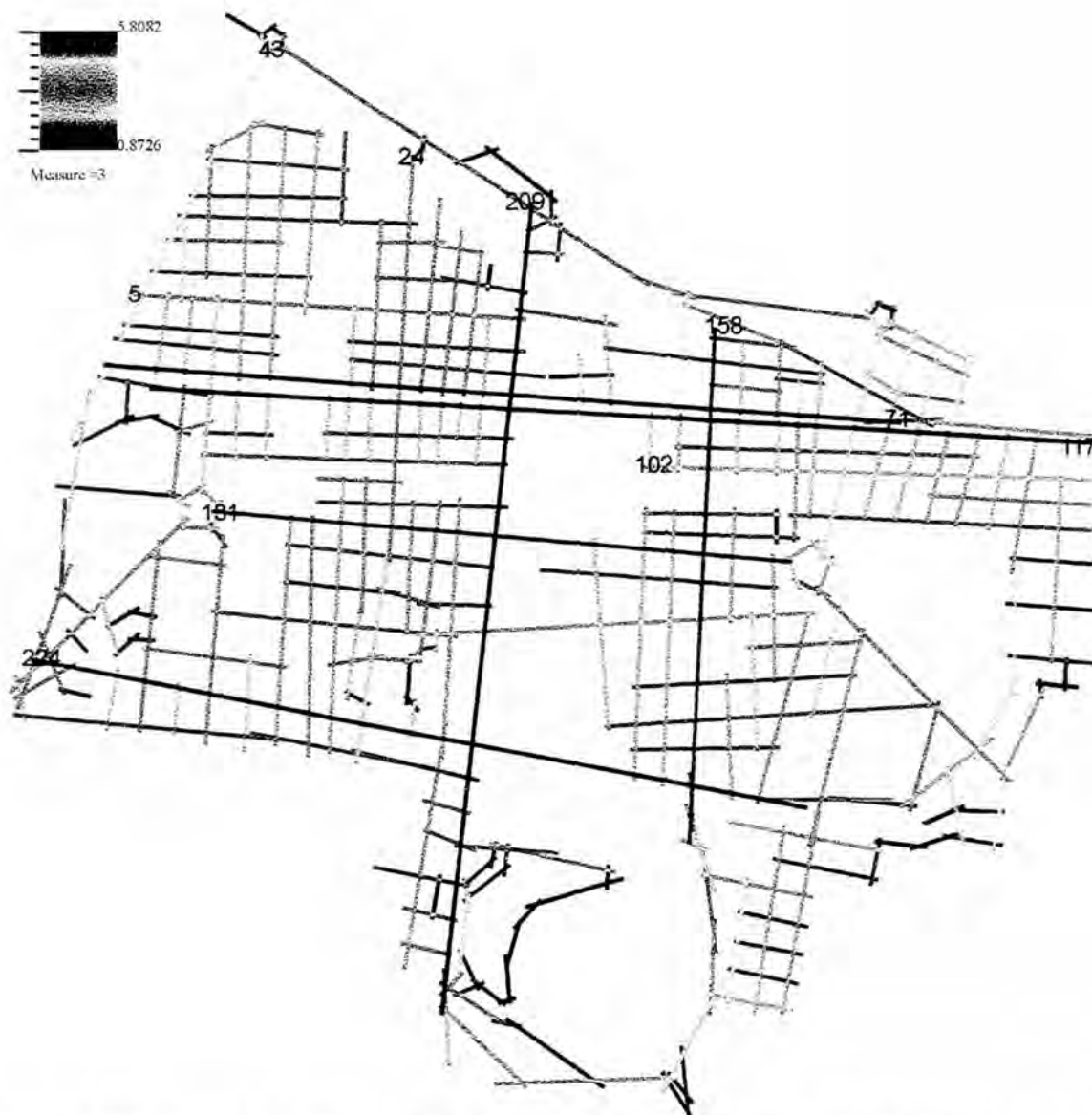
Fig. N° 6.22 – Plano N° 2 - Mapa Axial de Integração Local do Plano Diretor do novo Centro de Manágua, com valores de integração de 0,87 até 5,80.
