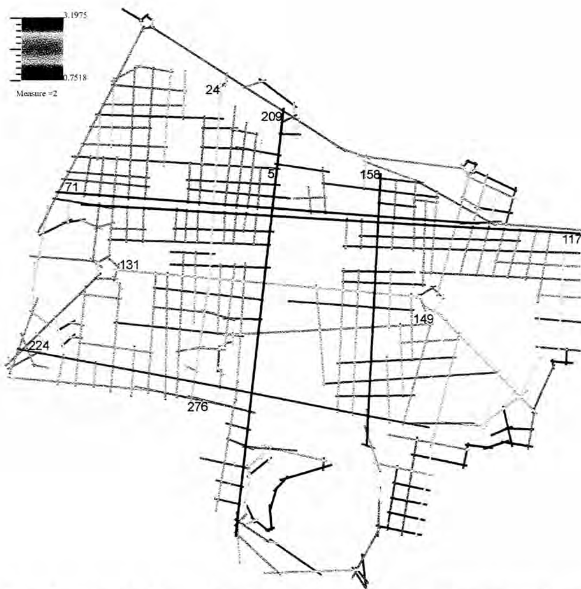
Fig. N° 6.20 – Plano N° 2 - Mapa Axial de Integração Global do Plano Diretor do novo Centro de Manáguas, com valores de integração de 0,75 até 3,19.
