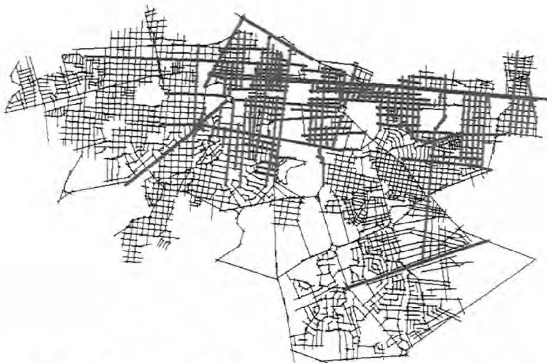
Fig. N- 6.27- Mapa representando 10% das linhas mais integradas (em vermelho), gerado dentro do software SIG "ArcView" (Plano N- 4).
