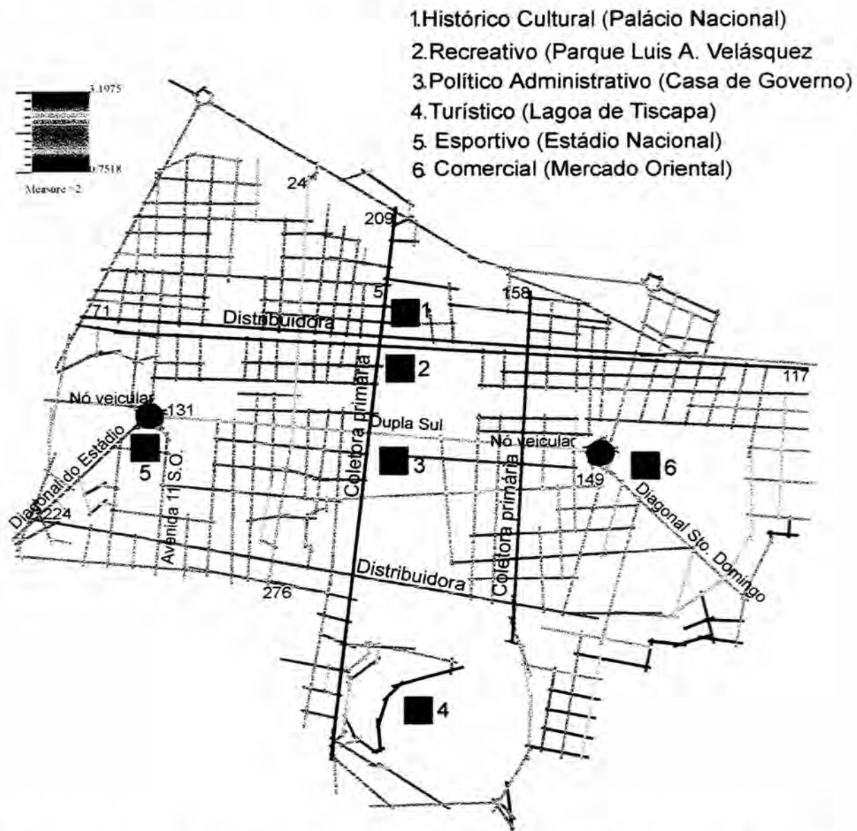
Fig. N. 6.41 - Principais Pólos Geradores de Tráfego no Plano Diretor do Centro de Manágua, montados no mapa de Integração global mostrando as 10 vias mais integradas do sistema .
