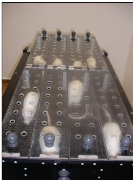
Figura 5 Esteira ergométrica adaptada para ratos
