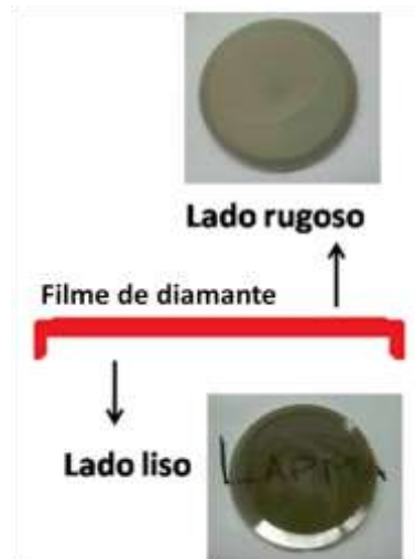
Figura 3.3: Esquema ilustrativo das superfícies do filme de diamante CVD obtidas a partir do substrato de zircônia [43] .
