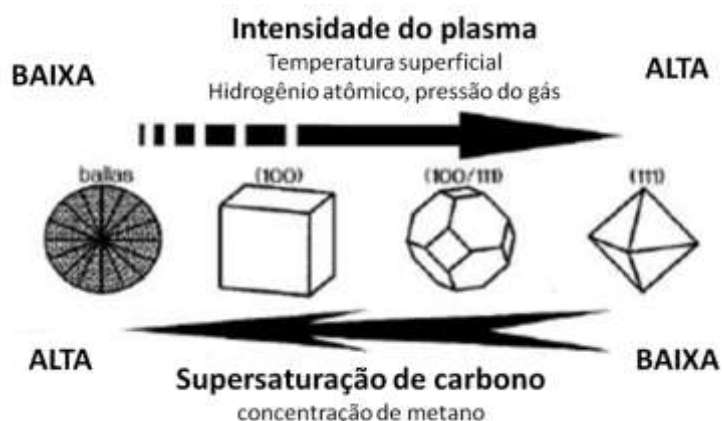
Figura 2.8: Influência dos parâmetros de deposição na morfologia do filme [75] .
