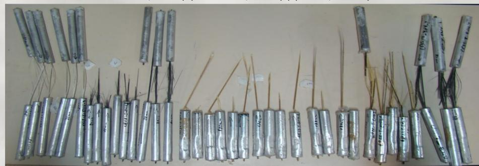
Figura 3. Aparência dos corpos-de-prova envelhecidos ao final do ensaio de tração.
