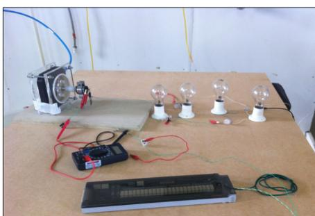
**Figura 2:** Circuito elétrico montado para a determinação da potência .
