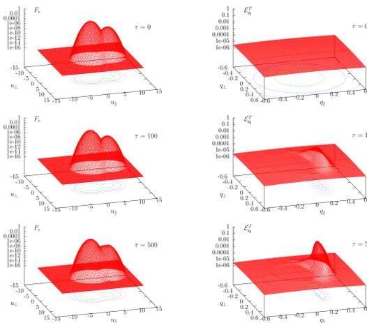
Na figura à esquerda podemos ver a evolução das modificações sofridas, no espaço de velocidades, pela função de distribuição, para diferentes tempos de integração. Na figura à direita, os tempos de integração são os mesmos e mostram o crescimento do espectro de amplitude das ondas de Langmuir, no espaço de vetor de onda.
