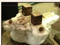
Figura 3 - Sistema de solidificação unidirecional envolvido em lã de rocha.
