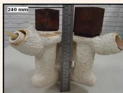
Figura 1 - Molde cerâmico com os blocos de cobre, altura total de 240 mm.
