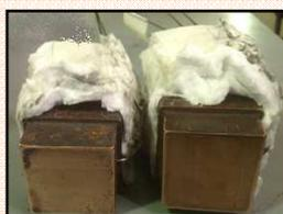
Figura 2 - Bloco de cobre isolado com lã de rocha.
