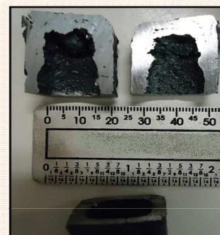
Figura 4 - Imagem do lingote solidificado. Na régua a escala está em milímetros.
