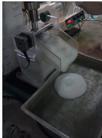
Figura 1: Ensaio de Flotação em célula mecânica
