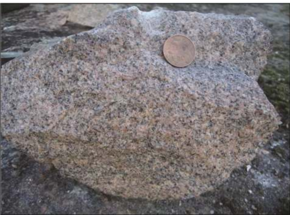
Figura 3 - Aspecto macroscópico da porção indeformada do granito Três Figueiras.
