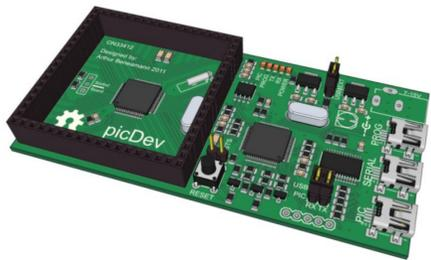
Figura 2. Placa de desenvolvimento para microcontroladores.
