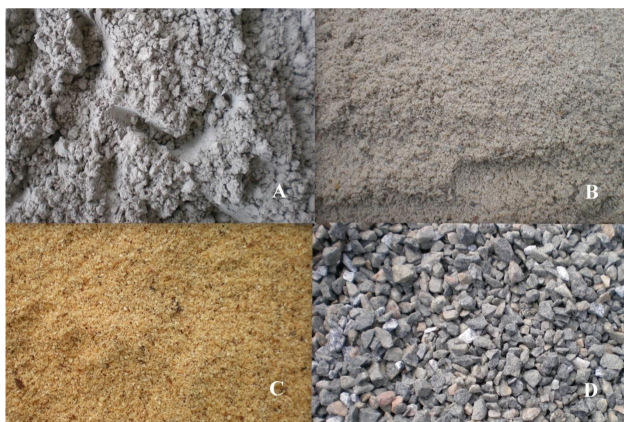
Figura 1 – Componentes dos concretos estudados: (A) cimento, (B) areia, (C) serragem e (D) brita.
