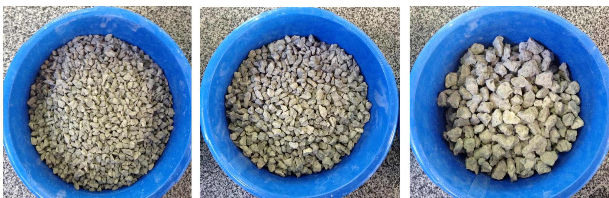
RCD separado em diferentes granulometrias
