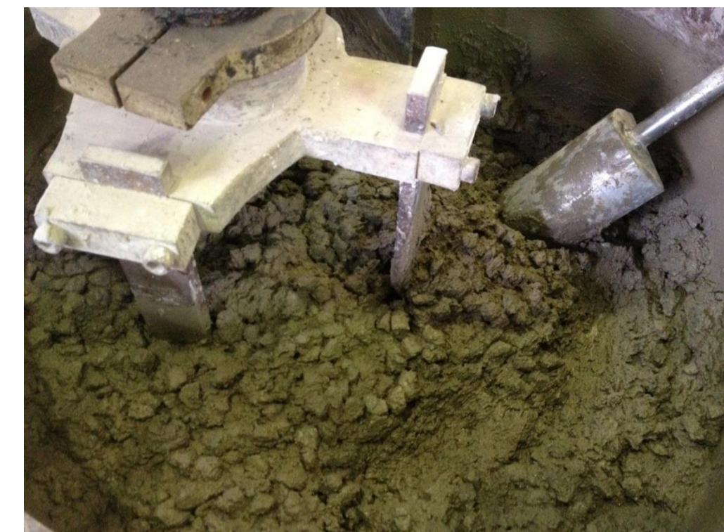
Produção do concreto em betoneira planetária de eixo vertical
