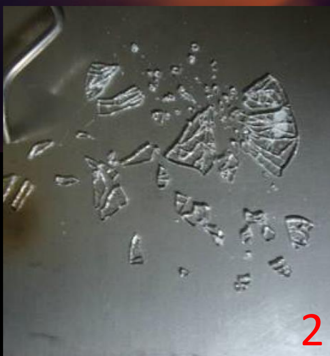
Imagem 2: Material com composição de Diopsídio, fundido e vertido sobre a chapa inox.
