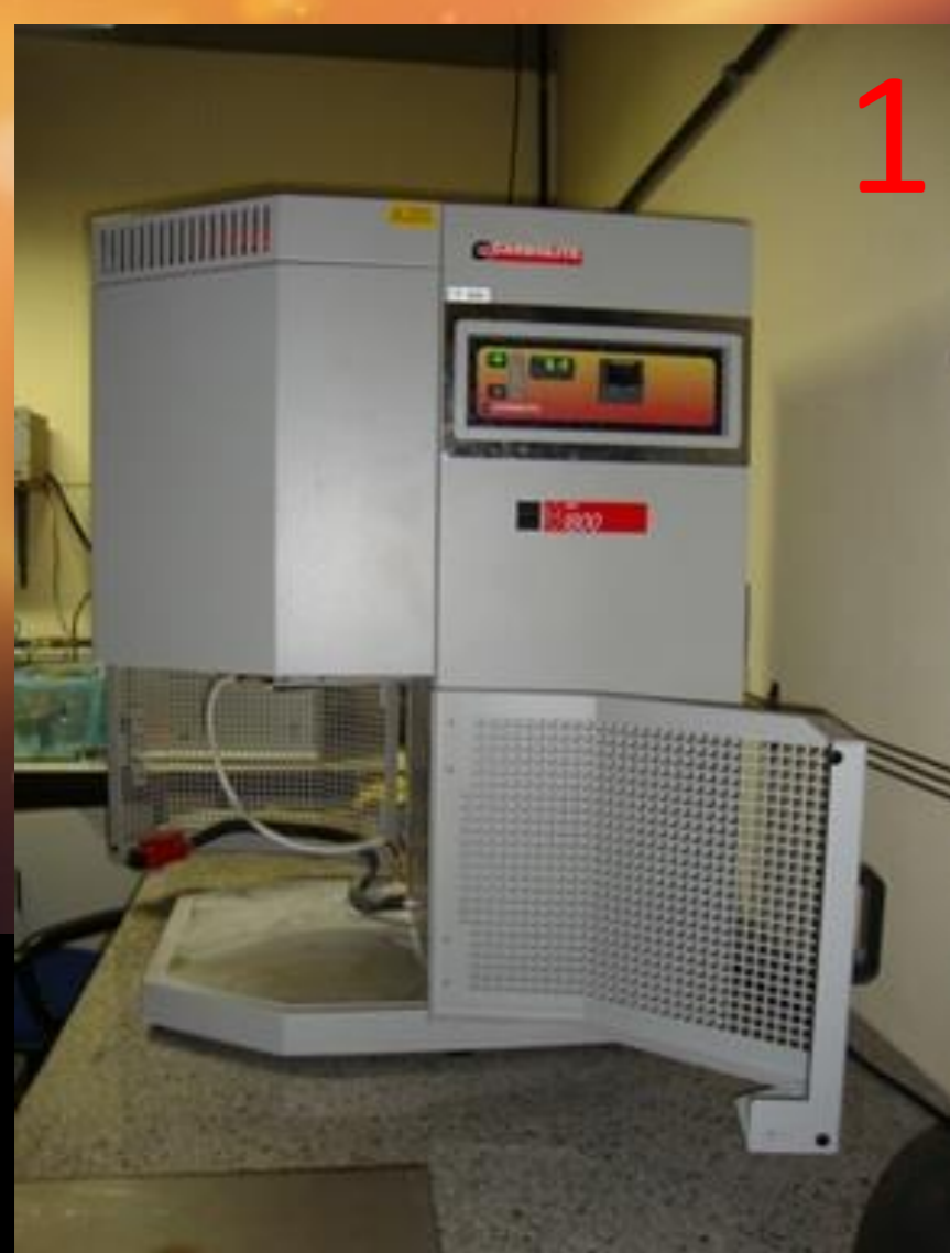
Imagem 1: Forno Carbolite BLF 18/3/3216P1, utilizado para fundir as misturas de óxidos e carbonatos
